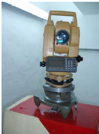
Φωτογραφία 2.9: Ολοκληρωμένος γεωδαιτικός σταθμός Topcon GPT 3105N
