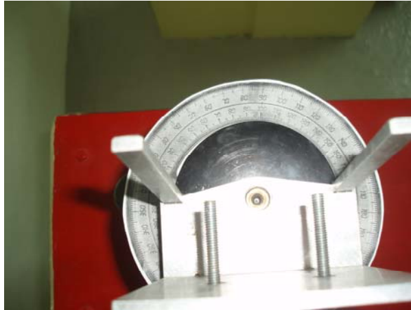
Φωτογραφία 2.4: Μοιρογνωμόνιο και βάση στήριξης
