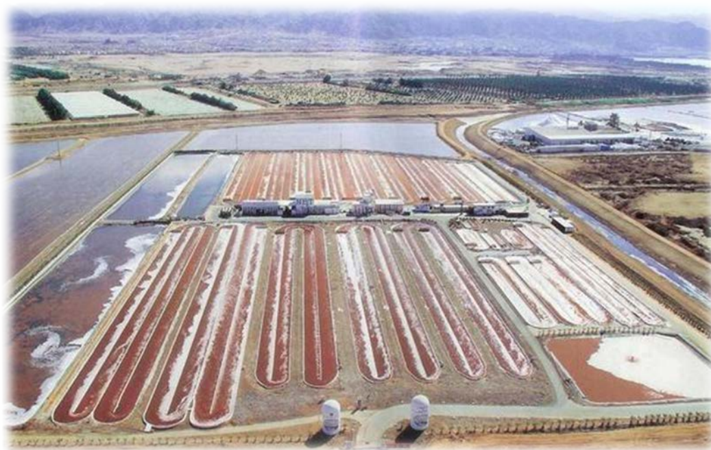
Σχήμα 2.6: Ανοιχτές δεξαμενές καλλιέργειας της άλγης Dunaliella με αναδευτήρες για καλύτερη κυκλοφορία του νερού
