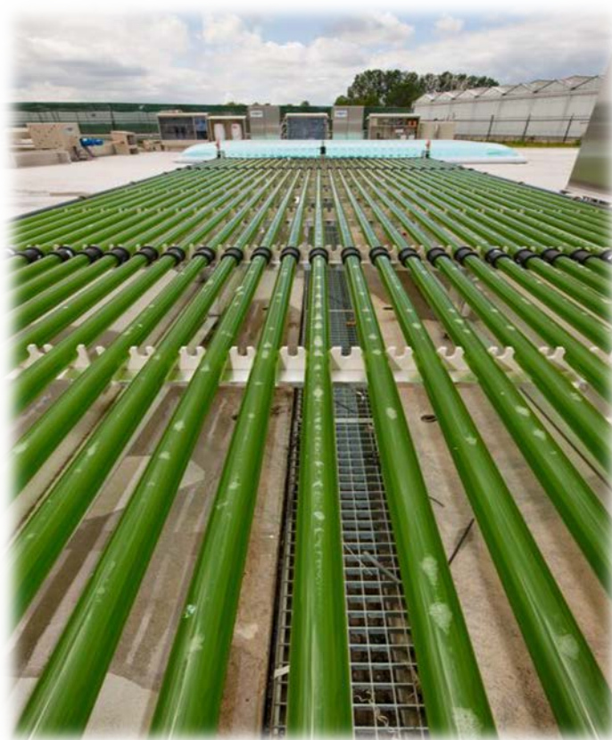
Σχήμα 2.2: Σύστημα αντιδραστήρων οριζόντιων σωλήνων [131]
