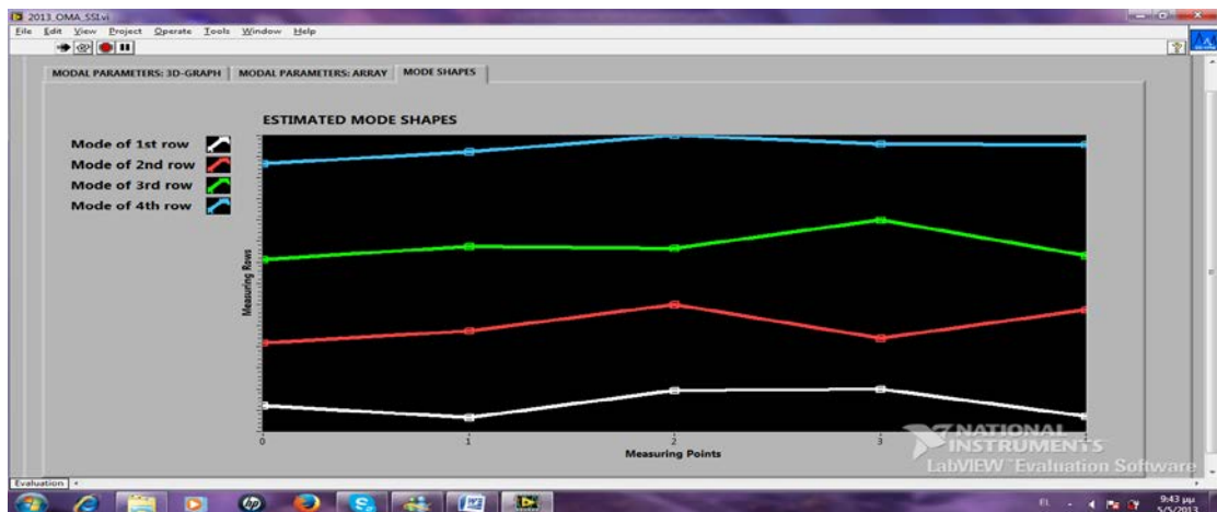
Σχήμα 3.26: Παρουσίαση ιδιομορφών ευρεθέντων ιδιοσυχνοτήτων. Παράδειγμα ιδιομορφής για την περίπτωση της πλάκας
