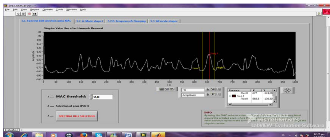
Σχήμα 3.14: Εφαρμογή του κριτηρίου MAC σε κορυφές της καμπύλης του πρώτου Singular Value
