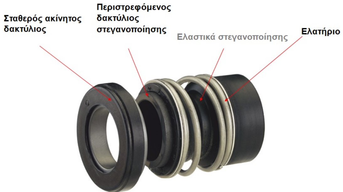
Σχήμα 1.14 Διπλός μηχανικός στυπιοθλίπτης Α
