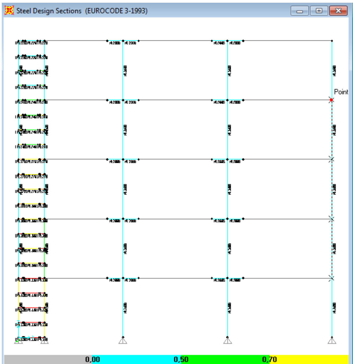
Σχήμα 10.2: Συντελεστές εκμετάλλευσης για τα σεισμικά φορτία του ικανοτικού στην όψη (x,z)
