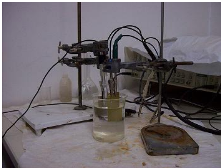
Εικόνα 2.6: Διάταξη μεθόδου TAFEL analysis
