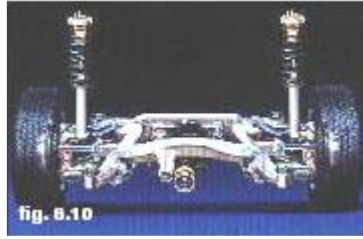
Εικόνα 1.8: Συγκολλητές διατομές 6063 συνδυαζόμενες με σωλήνες 5083 αποτελούν το μπροστινό και πίσω σύστημα ανάρτησης των μοντέλων της BMW σειράς 5.
