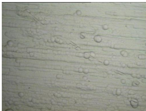
Σχήμα 2.9: Φωτογραφίες (x100) δοκιμών οπτικού μικροσκοπίου a) Ni – P, b) Ni – P – CeO 2 , c) Ni – P – TiO 2 , d) Ni – P – CeO 2 (T20), e) Ni – P – TiO 2 (T20)
