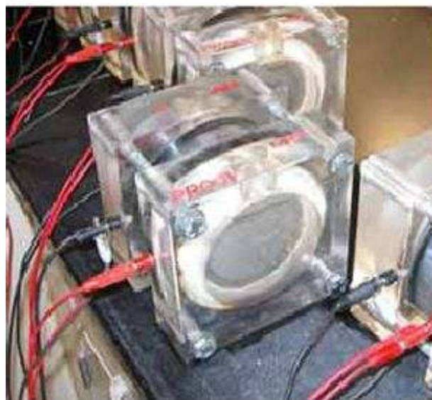
Εικόνα 10.16. Διάταξη μέτρησης διείσδυσης ιόντων χλωρίου
