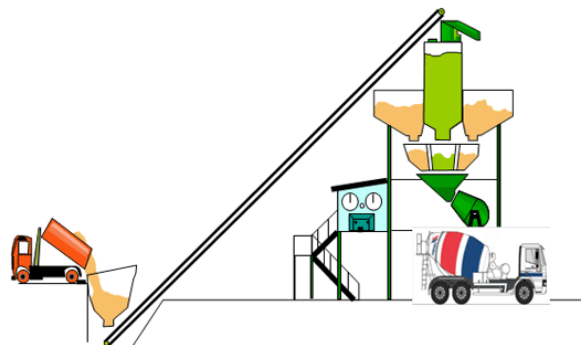
Εικόνα 4.2. Μονάδα με κεντρικό αναμικτήρα υγρής φόρτωσης
