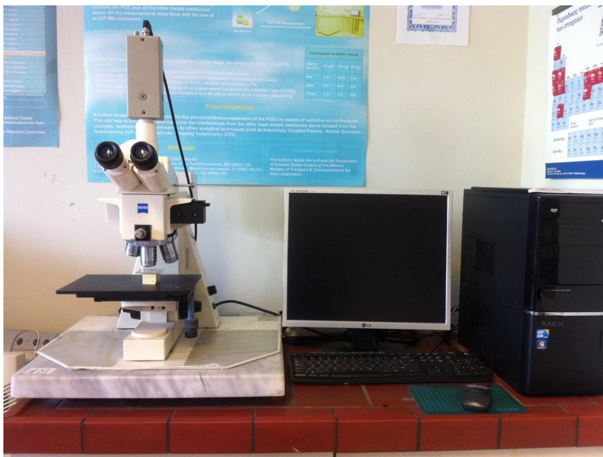
Εικόνα 1.1: Οπτικό μικροσκόπιο Zeiss Axiotech 100HD συνδεδεμένο με ηλεκτρονικό υπολογιστή που έχει εγκατεστημένο το λογισμικό του μικροσκοπίου
