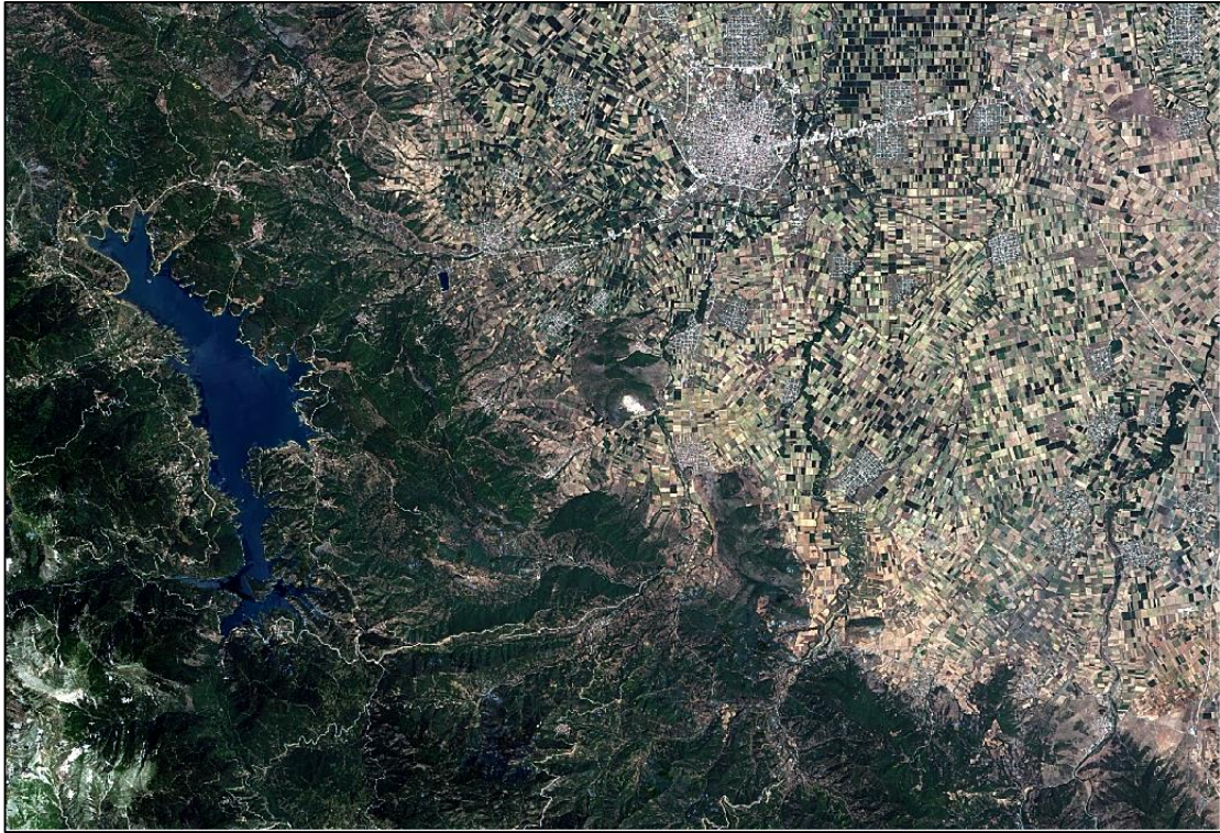
Εικόνα 6.12: Τελική εικόνα μετά την εφαρμογή του αλγορίθμου ανίχνευσης και αφαίρεσης συννέφων και σκιών
