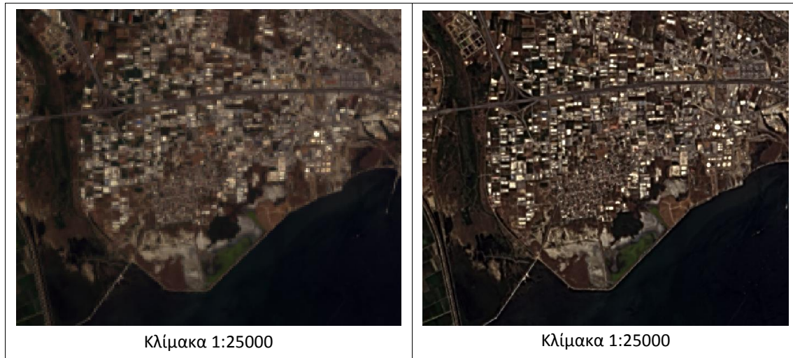
Πίνακας 6.7: Παράδειγμα εφαρμογής αλγορίθμου pansharpening του orfeotoolbox
