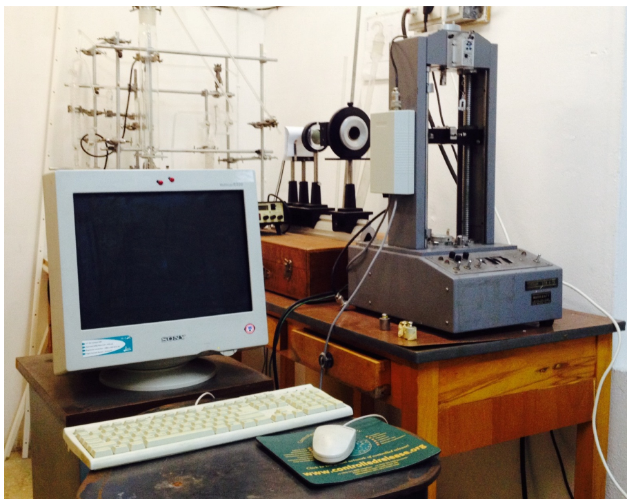
Σχήμα 4.9 Πειραματική διάταξη μέτρησης μέτρου ελαστικότητας
