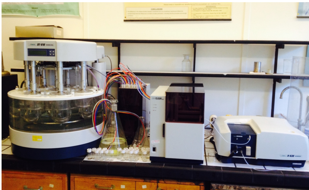
Σχήμα 4.12 Διάταξη αυτοματοποιημένης συσκευής διαλυτοποίησης στερεών φαρμακευτικών ουσιών.
