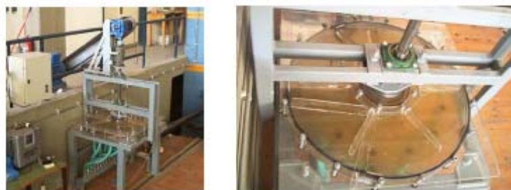
Σχήμα 4.10. Πειραματική διάταξη για τη μελέτη της ροής σε φυγοκεντρικές πτερωτές.
