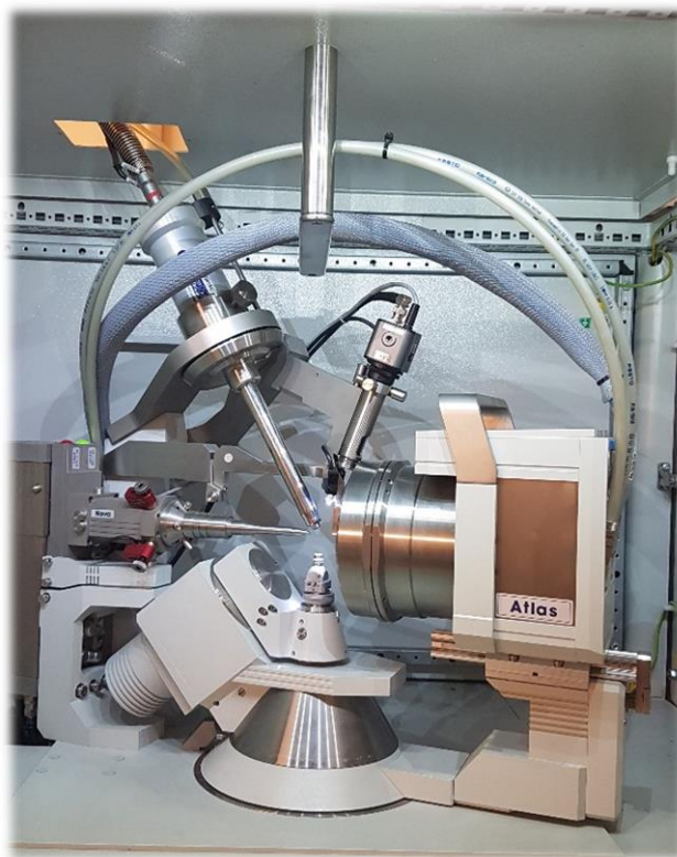
Εικόνα 8: Μονάδα πρωτεϊνικής κρυσταλλογραφίας ακτίνων Χ, εγκατεστημένη στο Ινστιτούτο Χημικής Βιολογίας του Εθνικού Ιδρύματος Ερευνών
