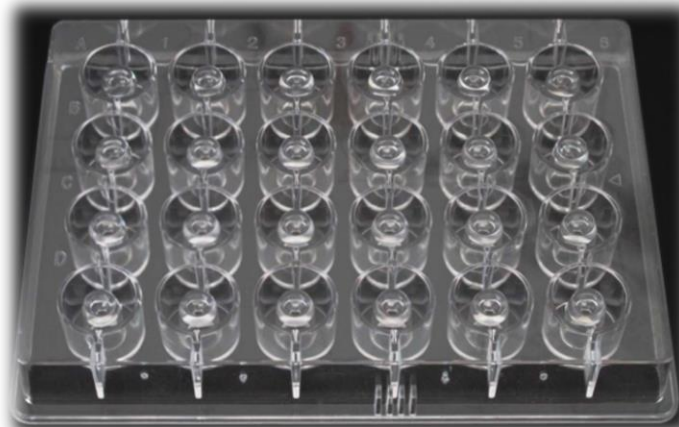
Εικόνα 6: Πλάκα κρυστάλλωσης καθήμενης σταγόνας 24 θέσεων [81]
