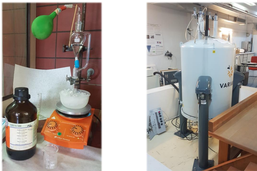
Εικόνα 5: Στα αριστερά η πειραματική διάταξη σύνθεσης του IV. Στα δεξιά ο φασματογράφος πυρηνικού μαγνητικού συντονισμού του Ινστιτούτου Χημικής Βιολογίας του Εθνικού Ιδρύματος Ερευνών, μέρος της Υποδομής Δομικής Βιολογίας Instruct-EL hub/Inspired
