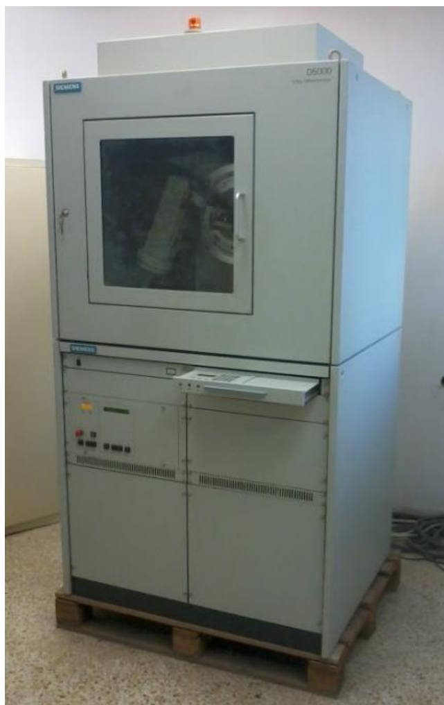
Εικόνα 5-20: X-Ray Siemens D5000 Diffractometer (αριστερά) και FEI-QUANTA 200 SEM συζευγμένο με αναλυτή EDS (δεξιά)
