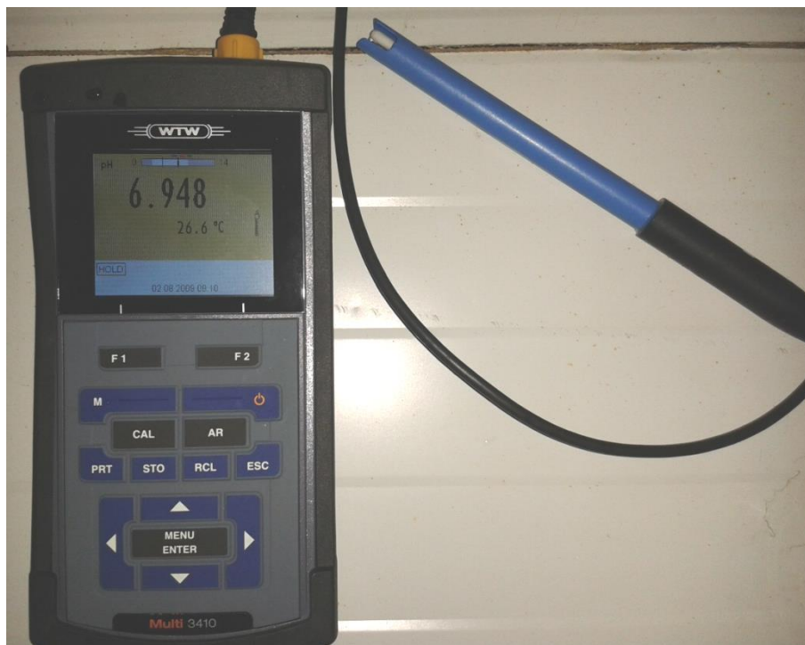
Εικόνα 5-17: Φορητό όργανο WTW και ηλεκτρόδιο μέτρησης pH
