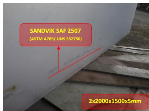
Εικόνα 5-1: Υλικά κατασκευής (αυλοί και φύλλα Super Duplex)
