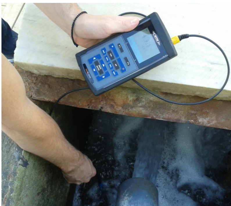
Εικόνα 5-18: Επιτόπου μέτρηση pH, εκροή μονάδας αφαλάτωσης Τήνου
