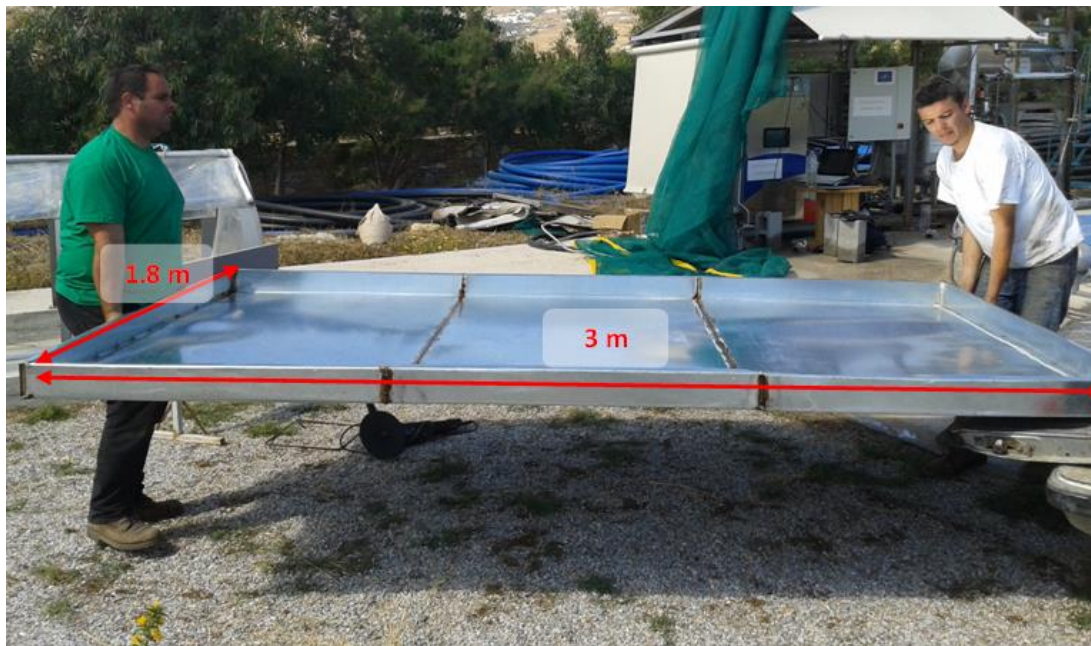
Εικόνα 5-28: Τοποθέτηση πλαισίων στο ξηραντήρα
