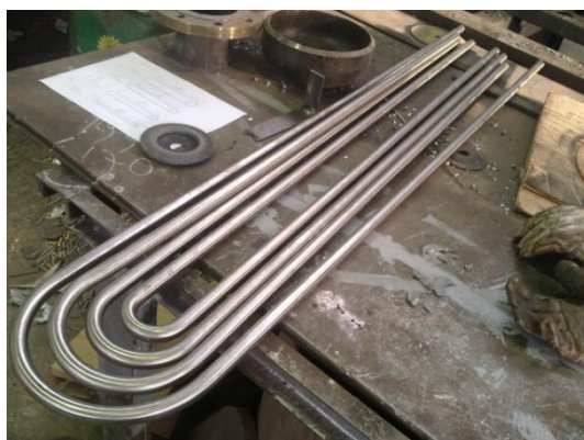
Εικόνα 5-2: Φωτογραφίες από την κατασκευή του εξατμιστήρα
