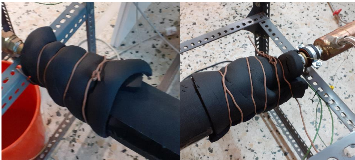
Σχήμα 4.22: Ad-hoc ακροχιτώνια θερμικής θωράκισης τοποθετημένα και στερεωμένα στο αριστερό και το δεξί άκρο της πειραματικής διάταξης
