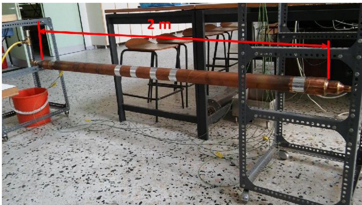
Σχήμα 4.14: Ο θερμαινόμενος κυλινδρικός αγωγός της πειραματικής διάταξης εξωτερικής ονομαστικής διαμέτρου 76 mm, ονομαστικού μήκους 2 m. Στις θέσεις που διακρίνονται με ταινία αλουμινίου βρίσκονται τοποθετημένα τα έξι θερμοστοιχεία warm side
