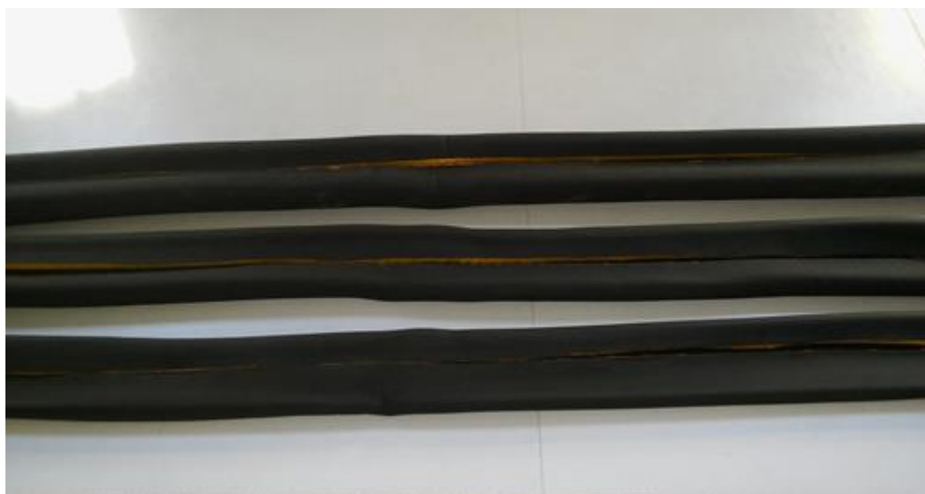
Σχήμα 4.2: Δοκίμια δοκιμαζόμενου θερμομονωτικού υλικού εταιρείας κατασκευής K-FLEX, τύπου K-FLEX ST TUBE, μήκους 2 m, πάχους 9, 13 και 19 mm, κυλινδρικής γεωμετρίας.
