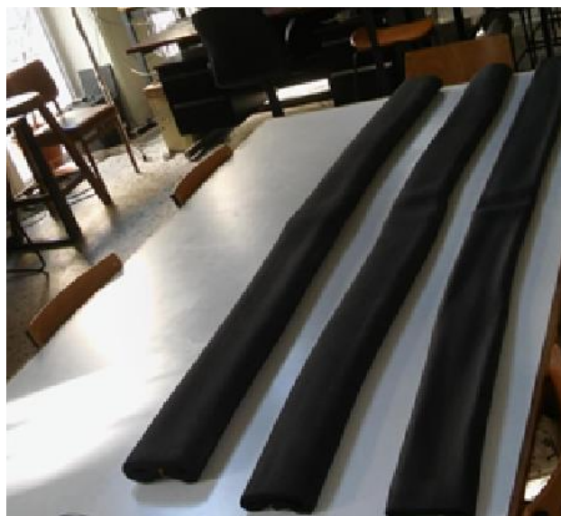
Σχήμα 4.1: Δοκίμια δοκιμαζόμενου θερμομονωτικού υλικού εταιρείας κατασκευής K-FLEX, τύπου K-FLEX ST TUBE, μήκους 2 m, πάχους 9, 13 και 19 mm, κυλινδρικής γεωμετρίας.
