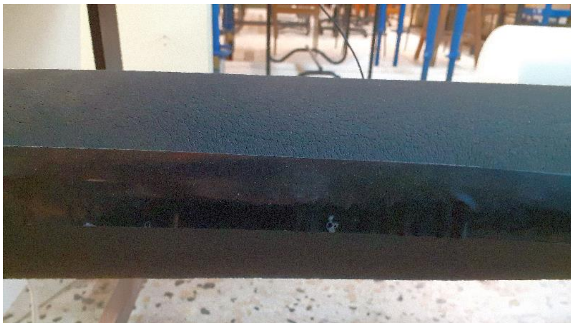
Σχήμα 4.20: Η τομή του δοκιμαζόμενου υλικού καλυμμένη με μαύρη ταινία κλιματισμού μικρού πάχους. Η τομή είναι τοποθετημένη περίπου κατά μήκος της ΒΑ ακμής του θερμαινόμενου κυλινδρικού αγωγού ώστε να μην συμπίπτει με θερμοστοιχεία της θερμής πλευράς.
