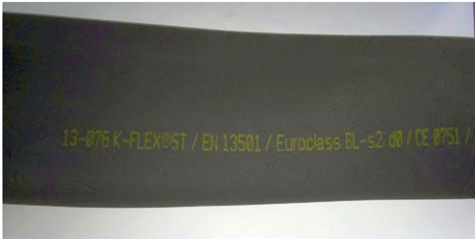
Σχήμα 4.3: Παράδειγμα εταιρική σήμανσης δοκιμαζόμενου θερμομονωτικού υλικού εταιρείας κατασκευής K-FLEX, τύπου K-FLEX ST TUBE. Διακρίνεται από αριστερά, το πάχος (13 mm), η εσωτερική ονομαστική διάμετρος (76 mm), ο τύπος του υλικού και ακολουθούν διάφορα πρότυπα με τα οποία συμμορφώνεται το προϊόν
