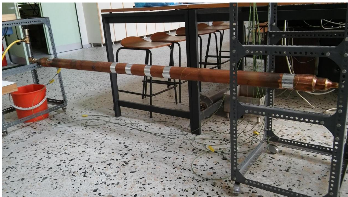
Σχήμα 4.5: Ο χάλκινος αγωγός της πειραματικής διάταξης εξωτερικής ονομαστικής διαμέτρου 76 mm, μήκους 2 m, αναρτημένος σε δύο απλά ικριώματα από Dexion τοποθετημένα στα δύο άκρα του.
