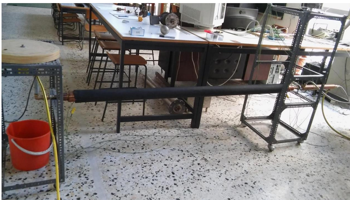
Σχήμα 4.21: Το δοκιμαζόμενο υλικό πλήρως τοποθετημένο στο θερμαινόμενο κυλινδρικό αγωγό. Διακρίνονται τα γυμνά από μόνωση άκρα της πειραματικής διάταξης.
