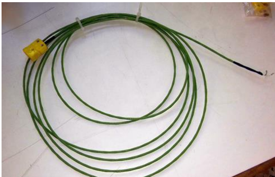
Σχήμα 4.27: Καλώδιο προέκτασης CHROMEL ALUMEL με θηλυκό βύσμα CHROMEL ALUMEL κατάλληλου μήκους για την πειραματική διάταξη
