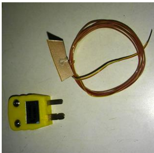
Σχήμα 4.26: Ένα αυτοκόλλητο θερμοστοιχείο τύπου SA1-K/ OMEGA Engineering INC με το καλώδιό του CHROMEL ALUMEL μήκους ~90 cm, διαμέτρου 0.25 mm. Αριστερά κάτω: αρσενικό βύσμα CHROMEL ALUMEL (ο ακροδέκτης CHROMEL διαφορετικός από τον ALUMEL, το υλικό ALUMEL είναι μαγνητικό)
