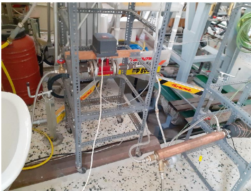
Σχήμα 4.8: Μέτρηση παροχής θερμού νερού προς την πειραματική διάταξη. Διακρίνεται από αριστερά: αγωγός εισόδου θερμού νερού στο ροόμετρο (τύπου flexible ½"), βάννα ρυθμίσεως παροχής ½", μαγνητικό ροόμετρο HEINRICHS EURO-PIK 567 ως συσκευή κόκκινου χρώματος συνδεδεμένο στο κύκλωμα με φλάντζες, και, αγωγός εξόδου θερμού νερού προς την πειραματική διάταξη (τύπου flexible ½")
