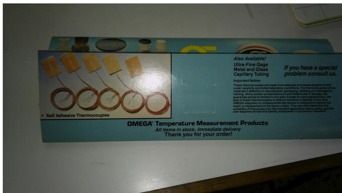
Σχήμα 4.13: Συσκευασία έξι θερμοστοιχείων Precision Fine Wire SA1-K, της OMEGA Engineering INC. Πάνω: εμπρός όψη, ετικέτα σήμανσης. Κάτω: Εικόνα περιεχομένου, διακρίνονται τα αυτοκόλλητα που χρησιμεύουν για τη στερέωση της αισθητήριας άκρης.
