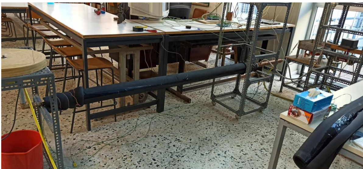
Σχήμα 4.23: Το δοκιμαζόμενο υλικό πλήρως τοποθετημένο στο θερμαινόμενο κυλινδρικό αγωγό. Διακρίνονται τα θερμικά θωρακισμένα άκρα της πειραματικής διάταξης.
