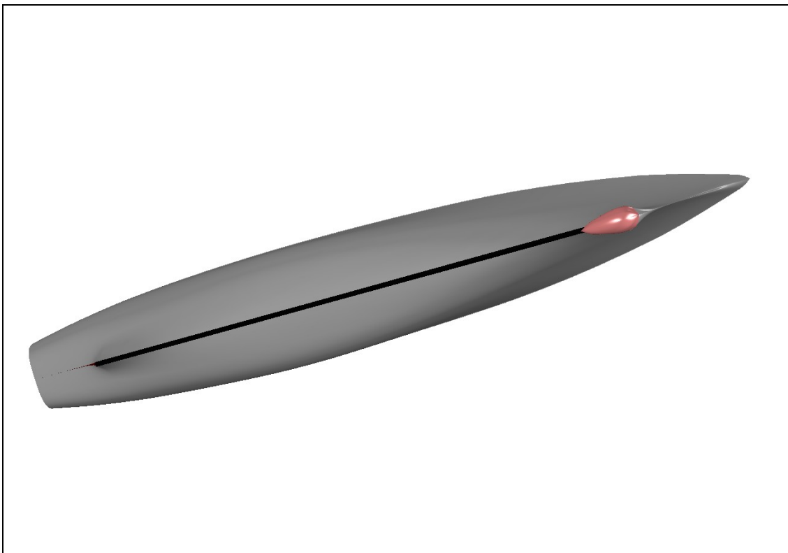
Σχήμα 3.3: Τελική επιφάνεια γάστρας από λογισμικό Maxsurf (όψη πυθμένα)
