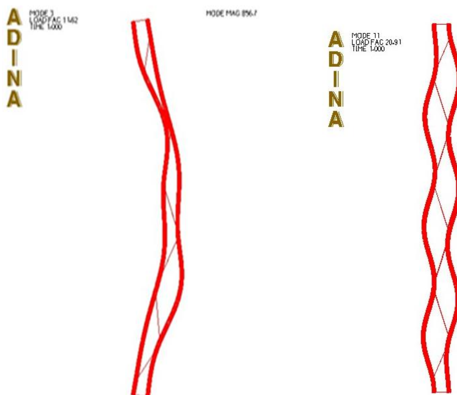
Σχ. 3.56 Πρώτη καθολική και πρώτη τοπική ιδιομορφή, 3 η και 11 η αντίστοιχα
