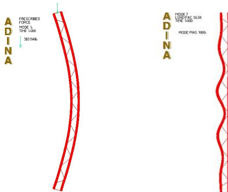
Σχ. 3.12 Πρώτη καθολική και πρώτη τοπική ιδιομορφή, 1 η και 7 η αντίστοιχα
