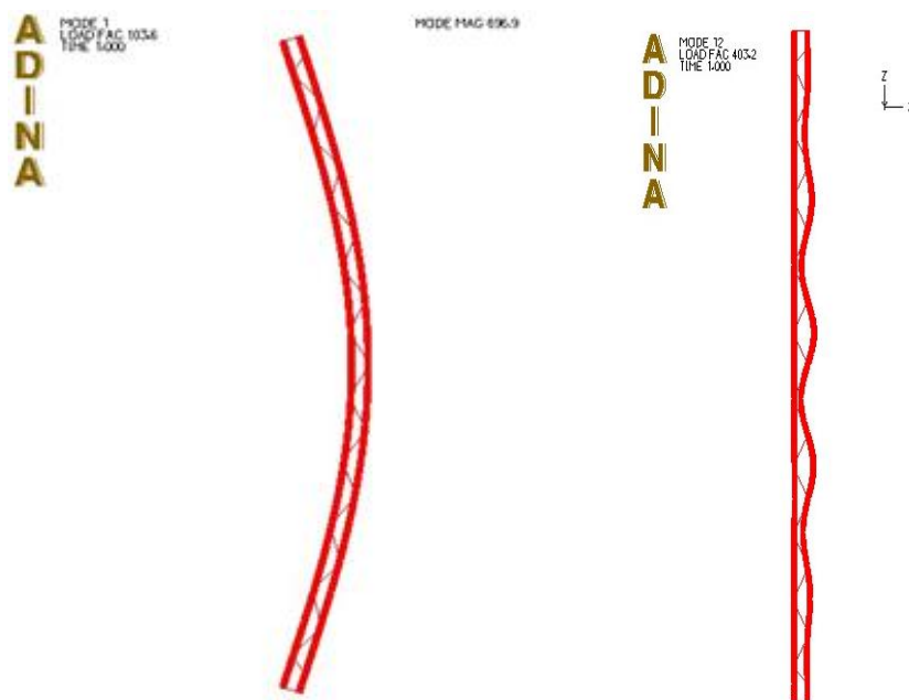
Σχ. 3.84 Πρώτη καθολική και πρώτη τοπική ιδιομορφή, 1 η και 12 η αντίστοιχα
