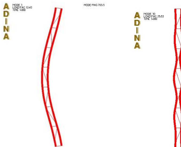
Σχ. 3.69 Πρώτη καθολική και πρώτη τοπική ιδιομορφή, 1 η και 10 η αντίστοιχα
