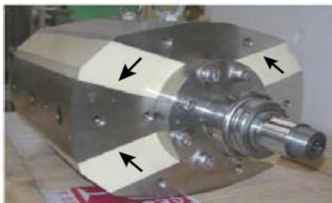
Σχήμα 6.17: Η εσωτερική δομή του μαγνήτη που κατασκεύασε ο Okamura [61]. Η εξωτερική δομή αποτελείται από έναν κύλινδρο από μαλακό μαγνητικό υλικό. Τα βέλη υποδεικνύουν την κατεύθυνση της μαγνήτισης των μαγνητών, οι οποίοι φαίνονται στο σχήμα με άσπρο χρώμα.
