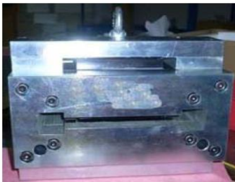
Σχήμα 6.10: Ο μαγνήτης που κατασκεύασε ο Tagliafico [83]. Το μαγνητοθερμιδικό υλικό περνά μέσω του διακένου που υπάρχει σε αυτή τη δομή και φαίνεται στο σχήμα
