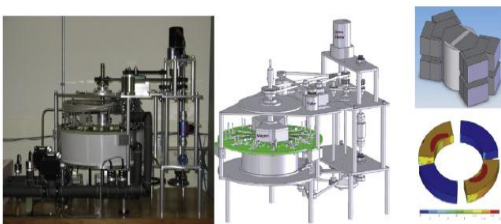
Σχήμα 2.20: Το μαγνητικό ψυγείο που δημιουργήθηκε στο Astronautics Corporation of America [68].
