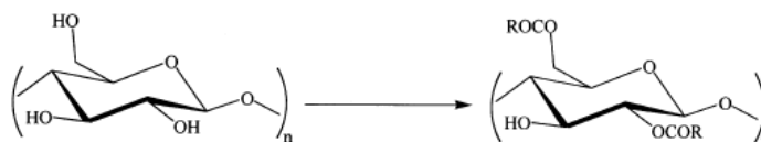
Σχήμα 2.3 Απεικόνιση μίας τυπικής δομικής μονάδας εστεροποιημένης κυτταρίνης ( DS=2 ) με αλειφατικές αλυσίδες μεγάλου μήκους.
