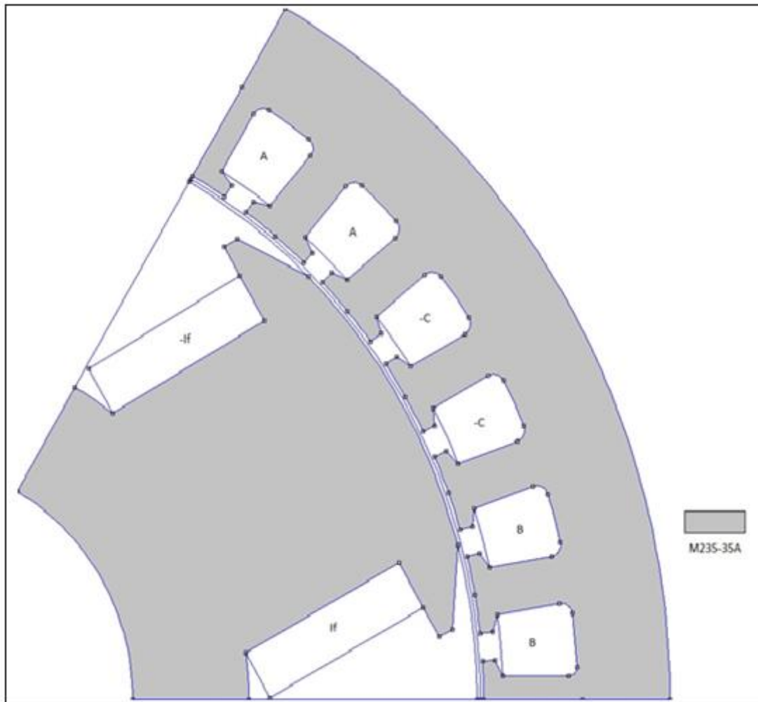
Σχήμα 4.14: Τελική διαμόρφωση γεννήτριας έκτυπων πόλων.
