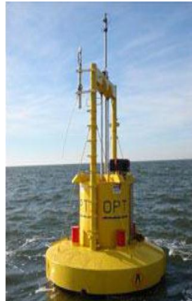
Εικόνα 1.20 OPT powerbuoy ονομαστικής ισχύς 40 kW
