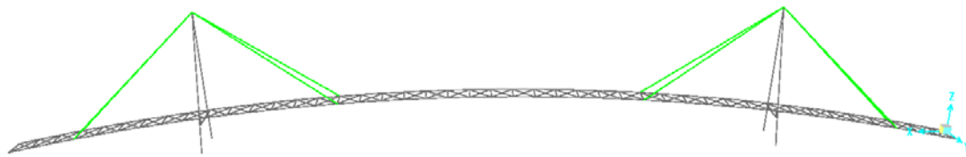
Σχήμα 4.20 Συνολικό προσομοίωμα γέφυρας
