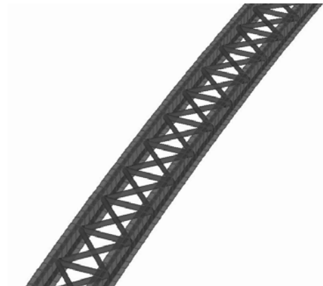
Σχήμα 3.4 Διαδοκίδες και χιαστί σύνδεσμοι, προσομοίωση το SAP2000
