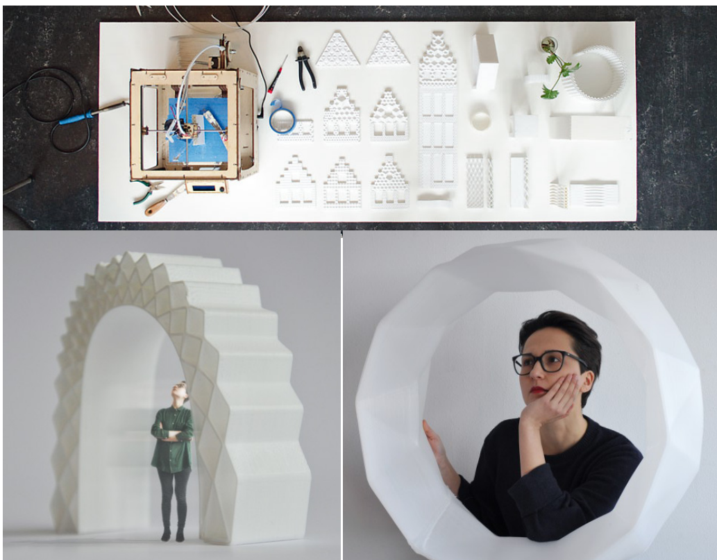
Εικόνα 4.19 - Τα τμήματα της κατοικίας εκτυπωμένα σε 1:20 (επάνω) και σε 1:1 (κάτω)
