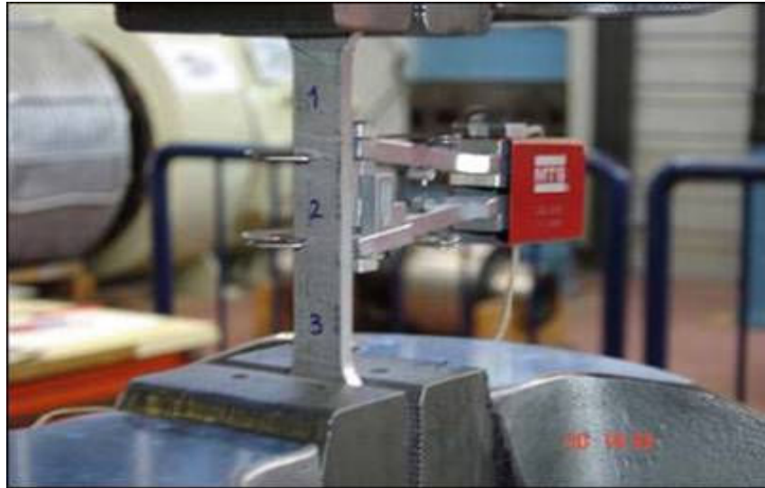
Εικόνα 4-8: Η πειραματική διάταξη κατά τις δοκιμές μονοαξονικού εφελκυσμού για τον προσδιορισμό των μηχανικών ιδιοτήτων του κράματος αλουμινίου 1561 με τη χρήση δοκιμίων τύπου “dogbone”. Διακρίνονται επίσης το επιμηκυνσιόμετρο και οι χρησιμοποιούμενες αρπάγες της μηχανής για τη συγκράτηση των δοκιμίων
