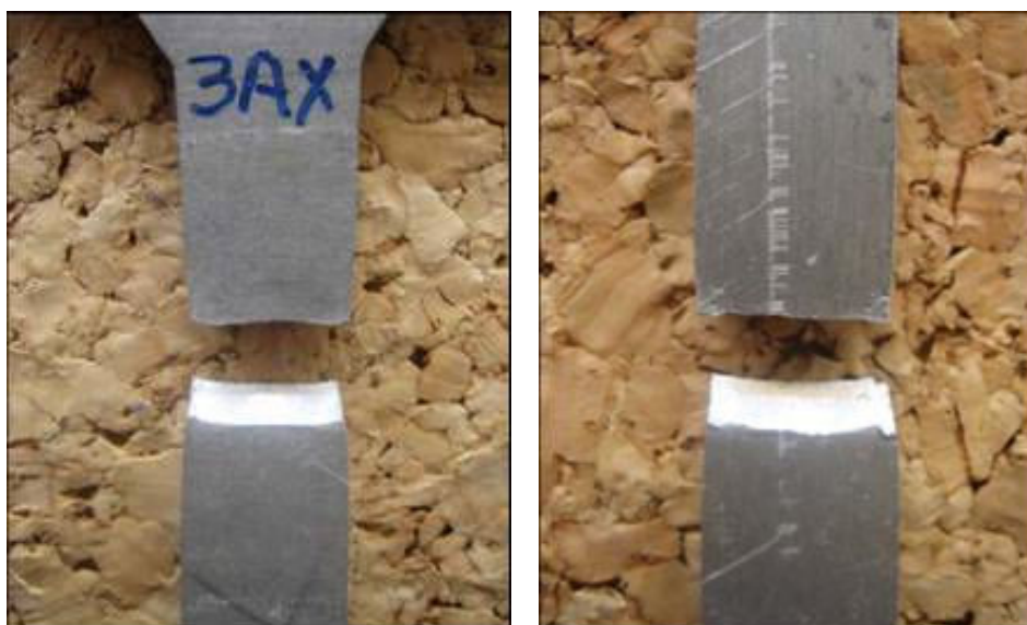
Εικόνα 4-19: Ο τρόπος θραύσης που παρατηρήθηκε στην πρώτη ομάδα πειραμάτων στα δοκίμια εφελκυσμού “dogbone”
