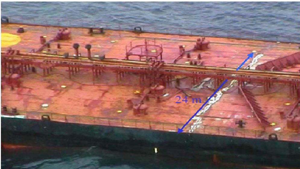
Εικόνα 4-1: Μακρο-ρωγμή μήκους 24 m στο κύριο κατάστρωμα του δεξαμενοπλοίου Castor [24] [πηγή IMO]
