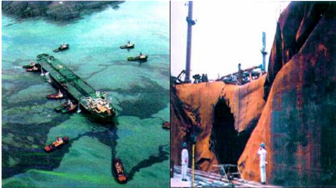
Εικόνα 2-11: Ναυτικά ατυχήματα στο παρελθόν : Προσάραξη (αριστερά) δεξαμενόπλοιου 147.000 dwt το 1996 και (δεξιά) το καταστροφικό αποτέλεσμα της σύγκρουσης επίσης ενός δεξαμενόπλοιου 100.000 dwt από ένα πλοίο μεταφοράς τυποποιημένων εμπορευματοκιβωτίων
