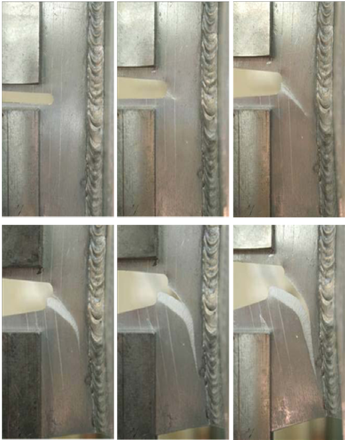
Εικόνα 4-39: Σταδιακή απεικόνιση των διακριτών βημάτων της ακολουθούμενης πορείας διάδοσης της ρωγμής στο ενισχυμένο δοκίμιο CT1W με συγκολλητό ενισχυτικό απλής λάμας και παρουσίαση των φαινομένων που παρατηρήθηκαν: έναρξη της ρωγμής, διάδοση της ρωγμής υπό γωνία 60^\circ σε σχέση με τη διεύθυνση της φόρτισης, αλλαγή κατεύθυνσης και διάδοση παράλληλα αλλά αντίθετα (υπό γωνία 180^\circ ) ως προς τη διεύθυνση της φόρτισης
