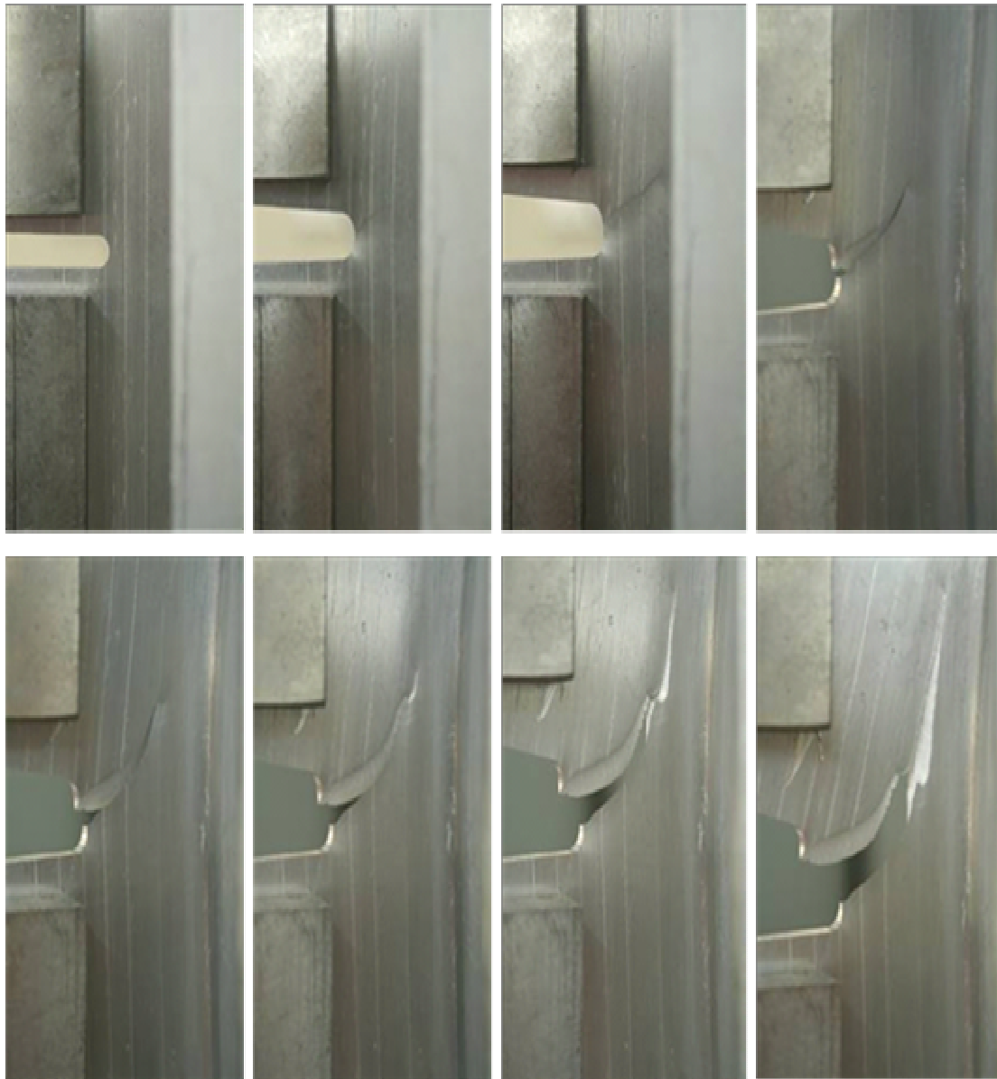
Εικόνα 4-33: Παρουσιάζονται τα διακριτά βήματα της πορείας διάδοσης της ρωγμής στο ενισχυμένο δοκίμιο CT2E με εξελασμένο ενισχυτικό τύπου-T και τα φαινόμενα που παρατηρήθηκαν: έναρξη της ρωγμής, διάδοσή της υπό γωνία 60^\circ σε σχέση με τη διεύθυνση της φόρτισης, παύση, στροφή, επανέναρξη, αλλαγή κατεύθυνσης και διάδοση παράλληλα ( 0^\circ ) ως προς τη διεύθυνση της φόρτισης και το ενισχυτικό
