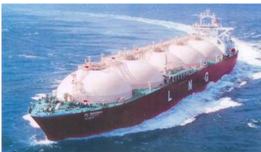
Εικόνα 2-6: Εφαρμογή των κραμάτων αλουμινίου στην κατασκευή των σφαιρικών δεξαμενών πλοίων μεταφοράς υγροποιημένου αερίου (LNG)
