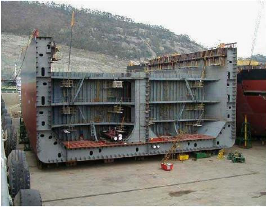
Εικόνα 3-6: Τυπική μορφή μέσης τομής μεταλλικής κατασκευής πλοίου
