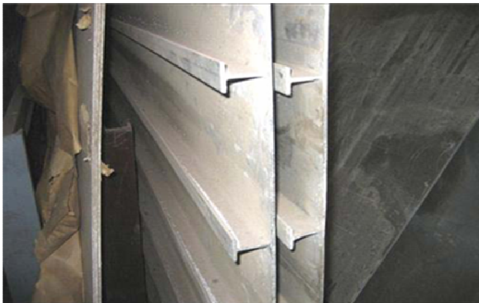
Εικόνα 4-4: Ναυπηγικά ελάσματα και ενισχυμένα πλαίσια αλουμινίου με εξελασμένα ενισχυτικά τύπου-T που χρησιμοποιούνται στις ναυπηγικές κατασκευές και από τα οποία κόπηκαν τα εξεταζόμενα δοκίμια εφελκυσμού
