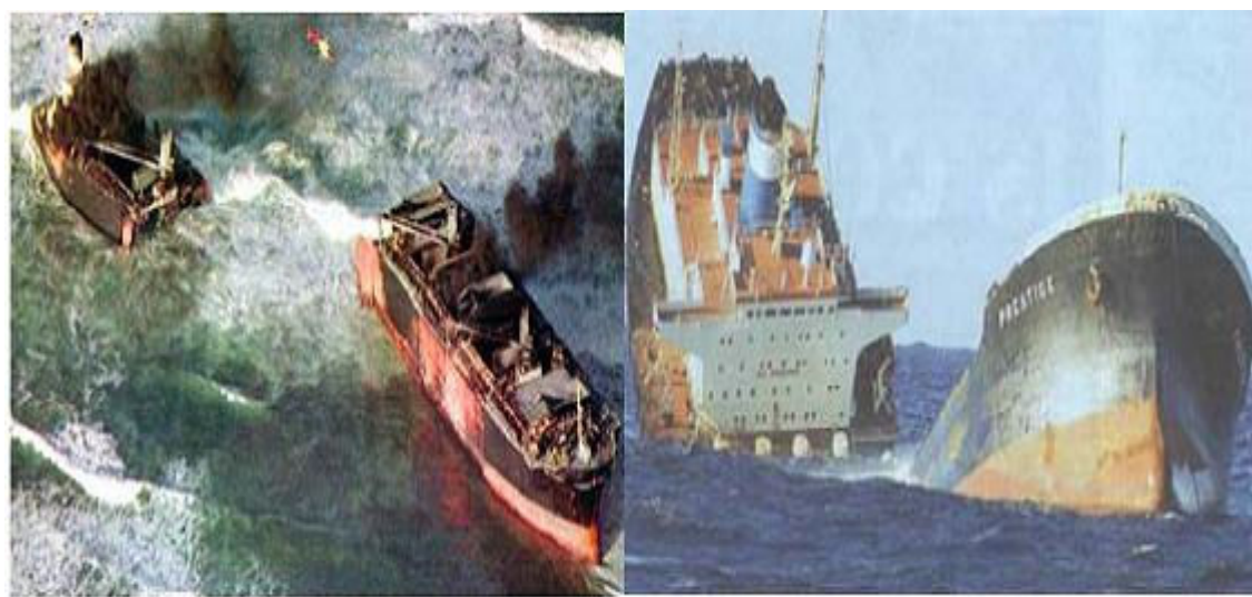
Εικόνα 2-12 : Βύθιση πλοίων λόγω κατάρρευσης της μεταλλικής κατασκευής τους
