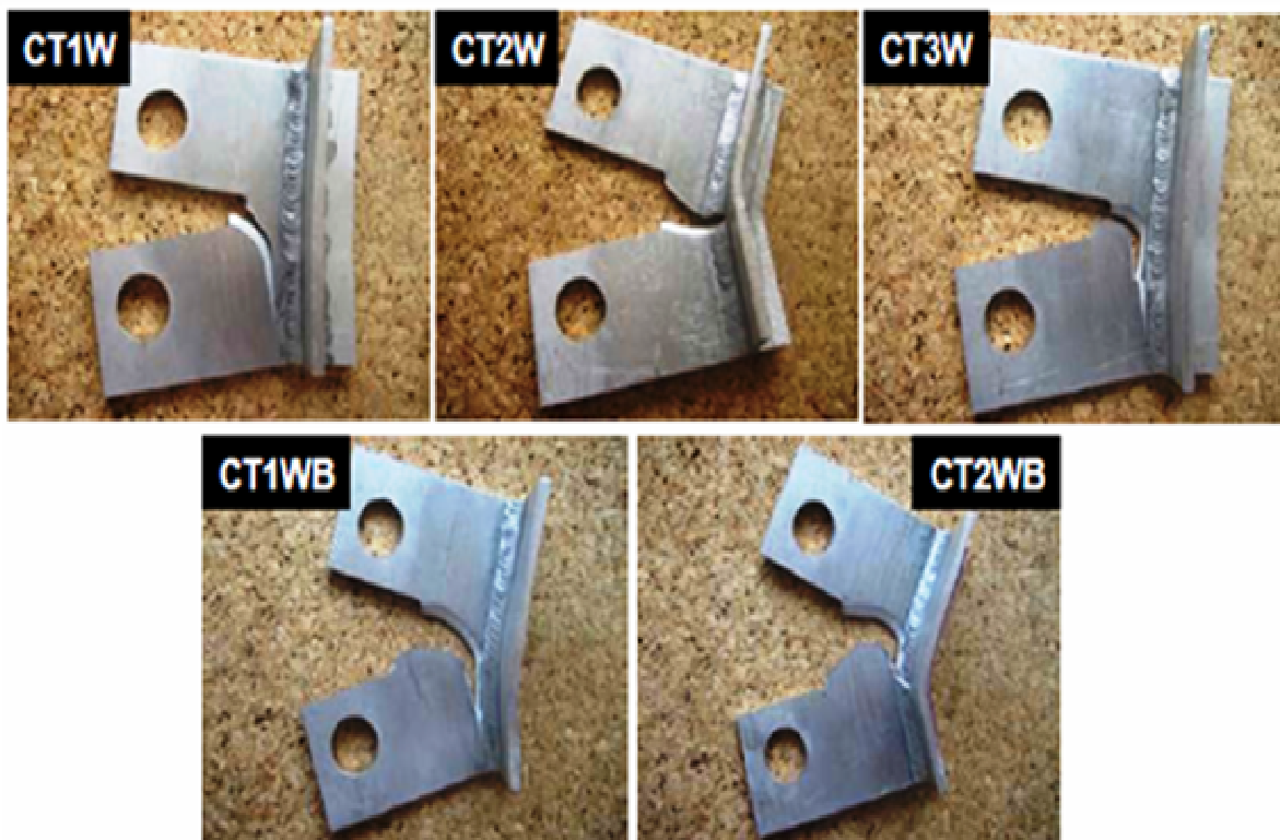
Εικόνα 4-37: Τελική μορφή των ενισχυμένων δοκιμίων εφελκυσμού CT i W ( i = 1, 2, 3 ) και CT i WB ( i = 1, 2 ) με συγκολλητά ενισχυτικά απλής λάμας μετά τη θραύση. Παρατηρούμε ότι η ρωγμή σε δύο περιπτώσεις, συγκεκριμένα στα δοκίμια CT 2 W και CT 2 WB, κατάφερε να διαδοθεί μέσω της συγκόλλησης και του ενισχυτικού. Στο δοκίμιο CT 2 W η ρωγμή διαπέρασε με την πρώτη τη συγκόλληση καθώς πλησίαζε στο ενισχυτικό. Αντίθετα, στο δοκίμιο CT 2 WB η ρωγμή τελικά εισχώρησε στη συγκόλληση υπό γωνία αφού όμως αρχικά είχε αποτύχει στην προσπάθειά της να περάσει μέσω της συγκόλλησης, συνεχίζοντας να διαδίδεται παράλληλα αλλά αντίθετα ( 180^\circ ) ως προς τη διεύθυνση της φόρτισης
