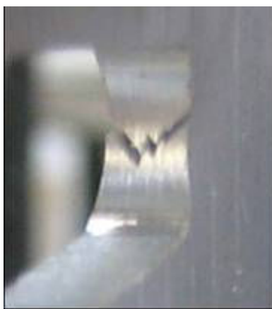
Εικόνα 4-45: Η μορφή της έναρξης της ρωγμής που παρατηρήθηκε κατά την εκτέλεση των πειραμάτων
