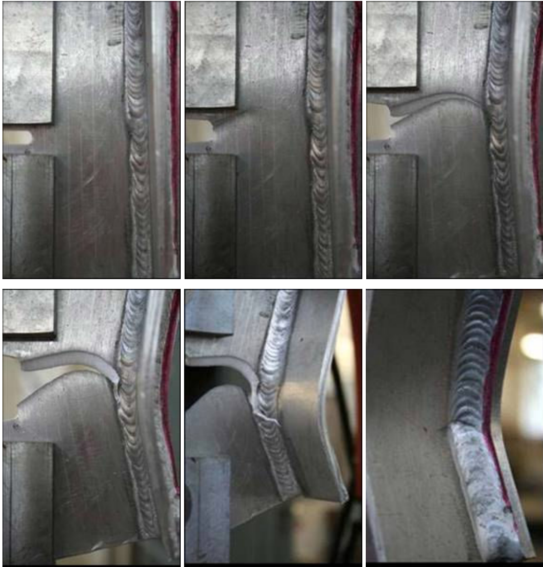
Εικόνα 4-42: Σταδιακή απεικόνιση των διακριτών βημάτων της ακολουθούμενης πορείας διάδοσης της ρωγμής στο ενισχυμένο δοκίμιο CT2WB με συγκολλητό ενισχυτικό απλής λάμας και μηδενική επιφάνεια ελάσματος στο πίσω μέρος του ενισχυτικού (rear plate = 0). Τα φαινόμενα που παρατηρήθηκαν είναι τα εξής: έναρξη και διάδοση της ρωγμής υπό γωνία 60^\circ σε σχέση με τη διεύθυνση της φόρτισης, στροφή σε μια κατεύθυνση κάθετα ως προς τη διεύθυνση της φόρτισης, αρχικά αποτυγχάνει στην προσπάθειά της να διαδοθεί μέσω της συγκόλλησης και του ενισχυτικού, στρίβει, αλλάζει προσανατολισμό και διαδίδεται παράλληλα αλλά αντίθετα (υπό γωνία 180^\circ ) ως προς τη διεύθυνση της φόρτισης, και σε κάποιο σημείο καταφέρνει να διαπεράσει τη συγκόλληση και το ενισχυτικό υπό ορισμένη γωνία και να διαδοθεί ταυτόχρονα στο ενισχυτικό αλλά και στην επιφάνεια του ελάσματος πίσω από αυτό με παρόμοιο ρυθμό προχώρησης
