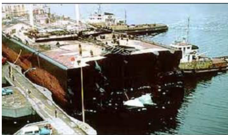
Εικόνα 3-13: Το ατύχημα του πλοίου MV Kurdistan που υπέστη ψαθυρή θραύση το 1979
