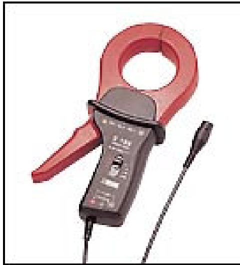
Εικόνα 2.5 : Παράδειγμα current probe τεχνολογίας HALL EFFECT
