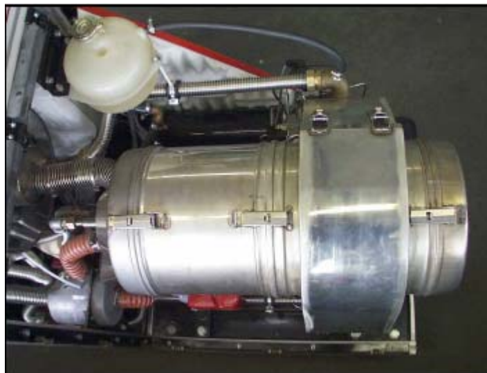
Θάλαμος καύσης από επανω, ανεμιστήρας συνδέσεις στα αριστερά
