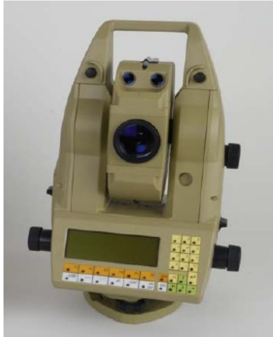
Σχήμα 4.1 Ο Γεωδαιτικός σταθμός Leica TCA1800
