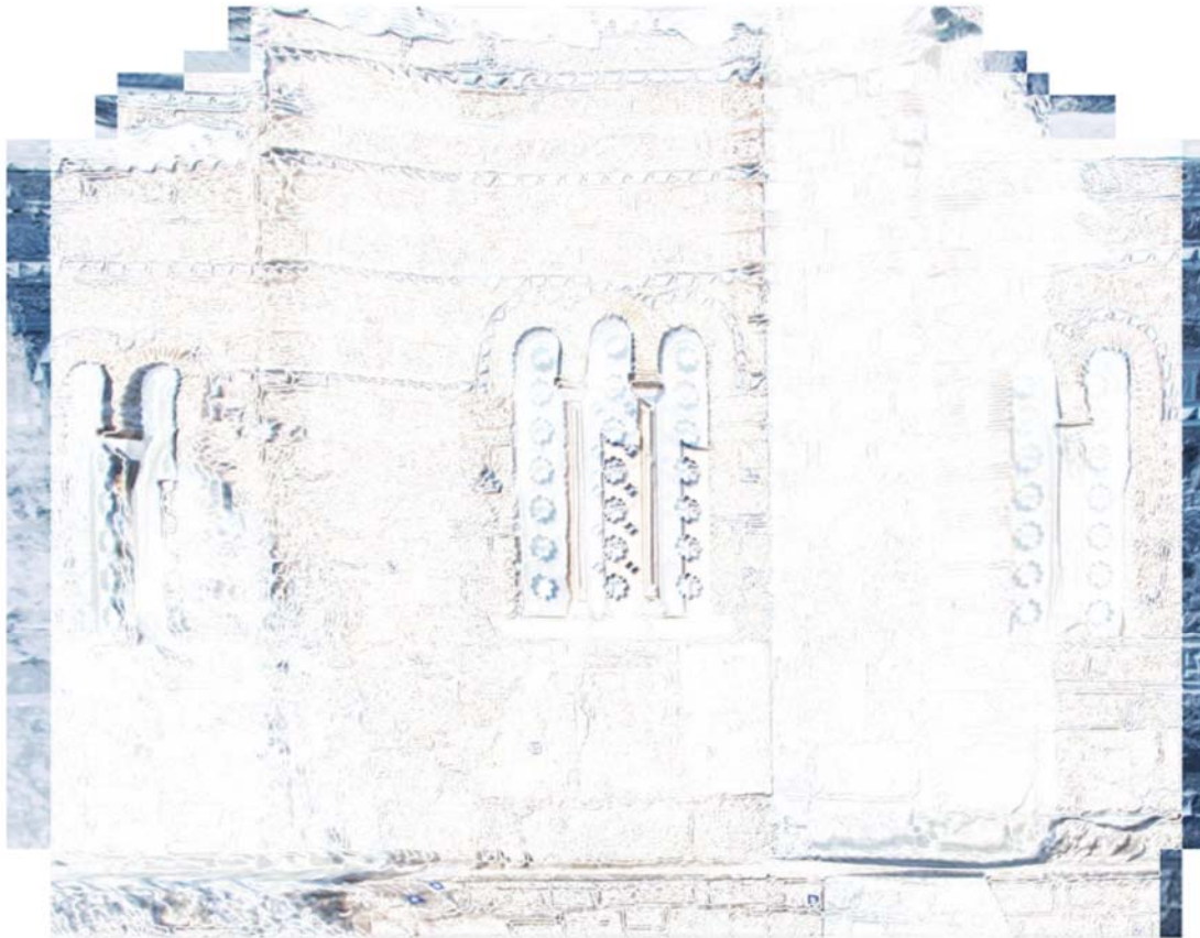
Εικόνα 5.3: Η εικόνα διαφοράς μεταξύ των ορθοφωτογραφιών του SSK με εικονοψηφίδα 10 και 15mm.
