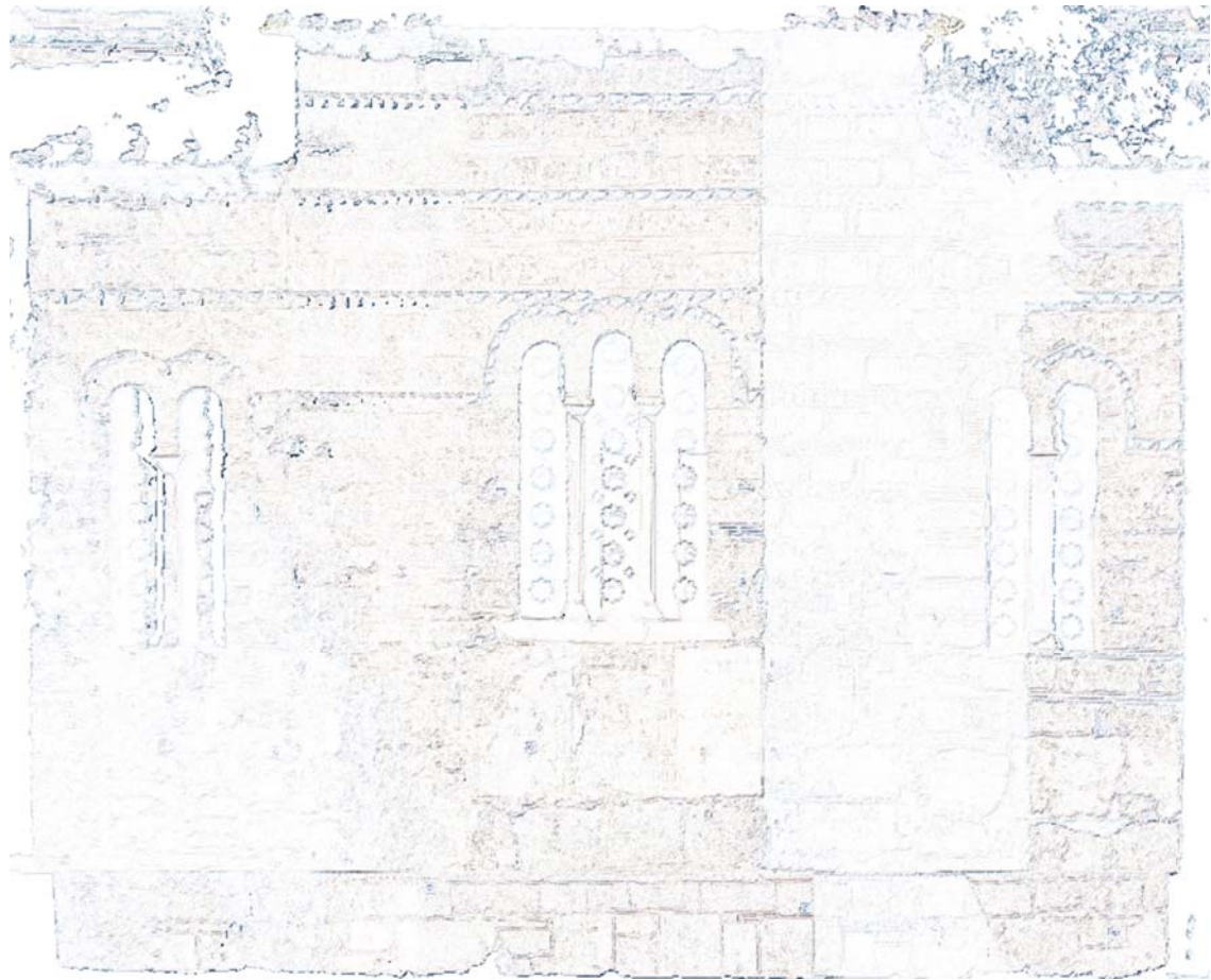
Εικόνα 5.8: Η εικόνα διαφοράς μεταξύ των ορθοφωτογραφιών του συνταχθέντος προγράμματος με εικονοπηφίδα 10 και 15mm.
