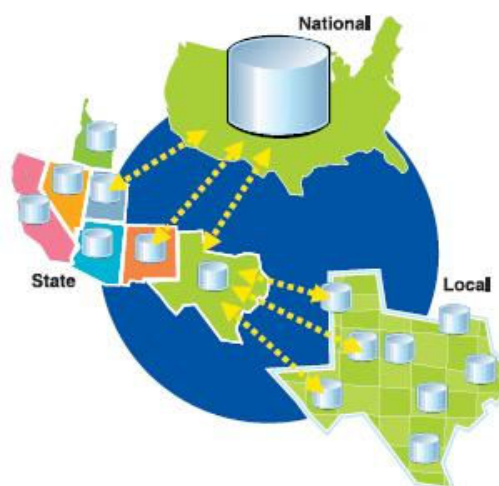
Εικόνα 3.20: Οι υπηρεσίες geodata είναι χρήσιμες για τον συγχρονισμό και ενημέρωση απομακρυσμένων βάσεων ArcSDE (ESRI, 2006)
