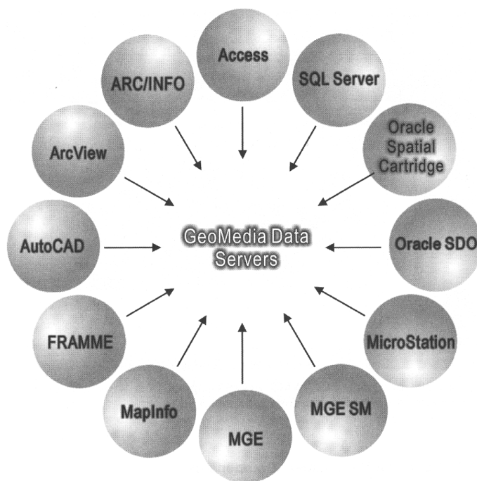
Εικόνα 3.5: Ικανότητα επικοινωνίας του εξυπηρετητή (server) δεδομένων με διάφορους τύπους αρχείων (Penq and Tsou, 2003)
