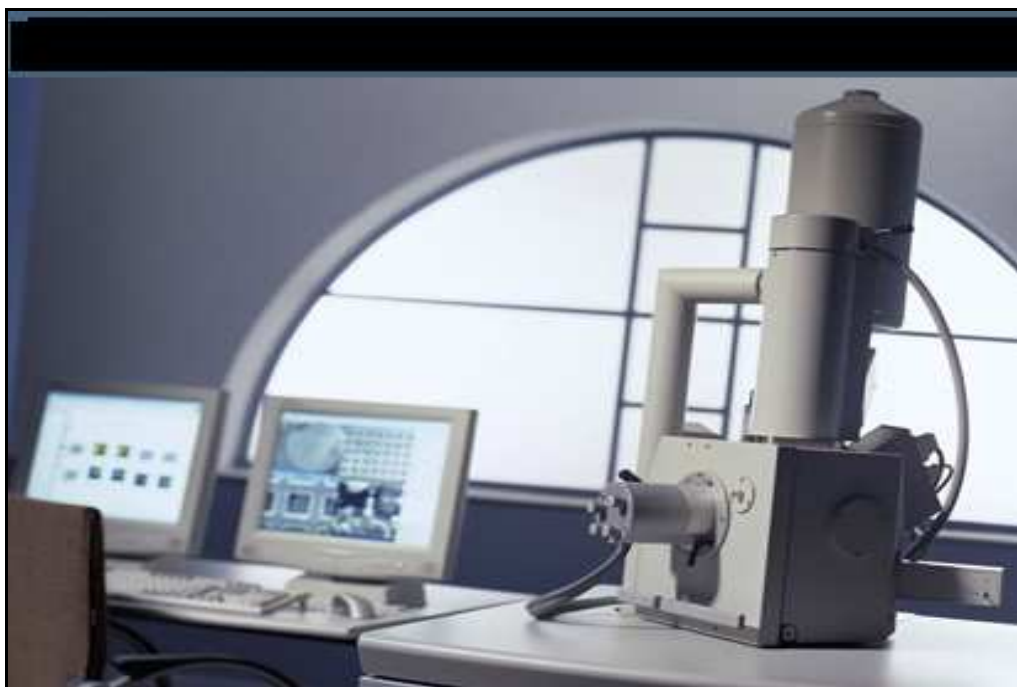
Εικόνα 4.1 : Ηλεκτρονικό μικροσκόπιο σάρωσης, μοντέλο Quanta 200 της εταιρείας FEI [45].
