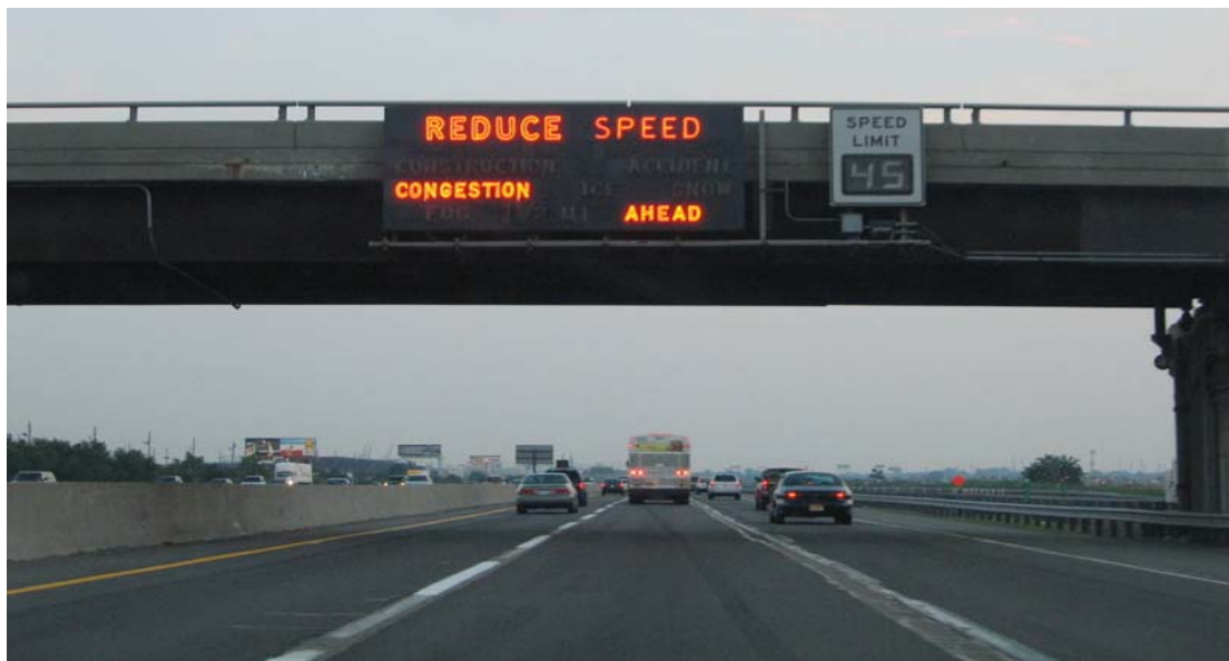
ΕΙΚΟΝΑ 1-2: ΠΑΡΑΔΕΙΓΜΑ ΧΡΗΣΗΣ ΤΩΝ ΜΕΤΑΒΛΗΤΩΝ ΜΗΝΥΜΑΤΩΝ ΣΤΟΝ ΑΥΤΟΚΙΝΗΤΟΔΡΟΜΟ I -95 (NEW JERSEY)
