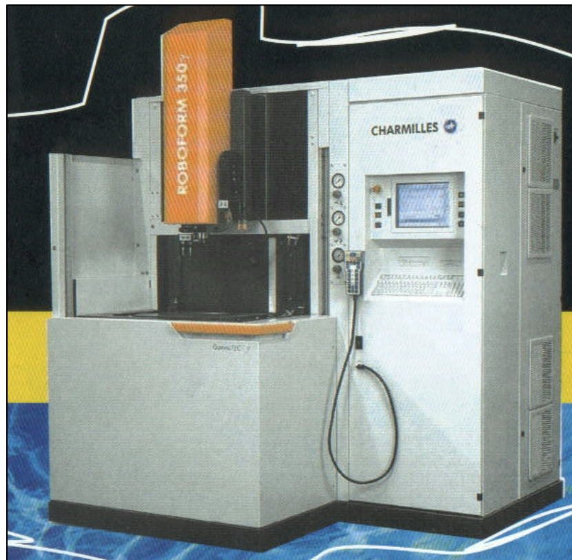
Σχήμα Ε.3-Μηχανή ηλεκτροδιαβρωσης αποτύπωσης
