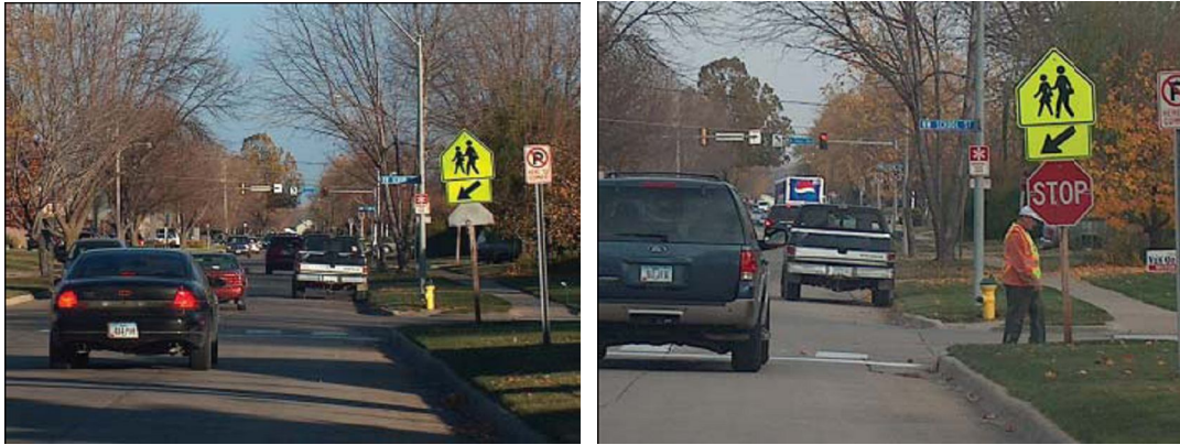
Εικόνα 2-34 (α και β): Αναδιπλούμενο στοπ εκτός ωρών σχολικών ρυθμίσεων και σε χρήση
