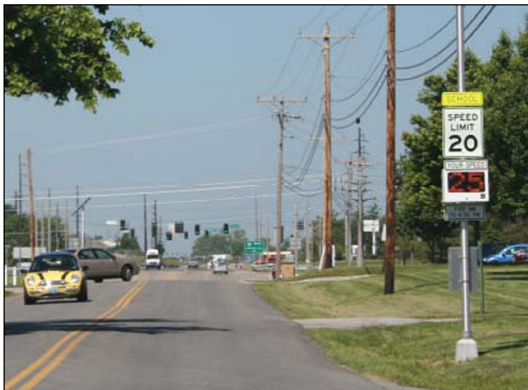
Εικόνα 2-4: Μηχανισμός αναγραφής ταχύτητας κινούμενου οχήματος
