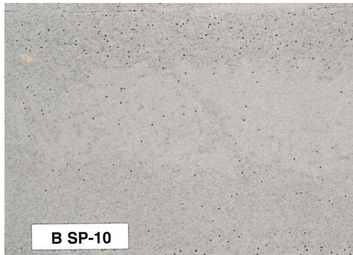
Βαθμός προετοιμασίας επιφανείας Sa 2 ½ (Σχεδόν λευκή ψηγατοβολή-Near White Metal Blast Cleaning)
