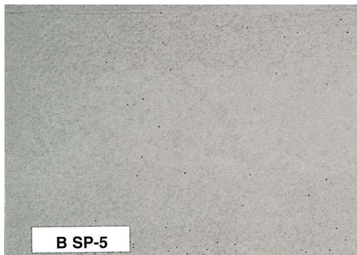
Βαθμός προετοιμασίας επιφανείας Sa 3 (Λευκή ψηγατοβολή-White Metal Blast Cleaning)
