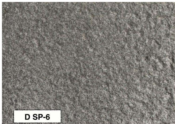
Βαθμός καθαρότητας επιφανείας Sa 2 (Εμπορική Ψηγματοβολή – Commercial Blast Cleaning)
