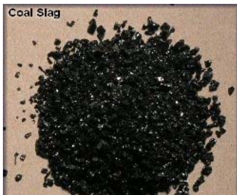
Εικόνα 3.5: Κόκκοι αποκαμιινεύματων άνθρακα
