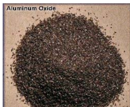
Εικόνα 3.6: Κόκκοι οξειδίου του αλουμινίου
