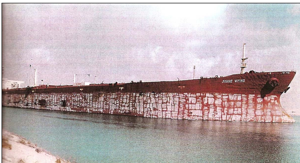
Εικόνα 2.9: Παράδειγμα επιτυχημένης χρήσης αυτολειαινόμενων αντιρρυπαντικών στα ύφαλα ενός δεξαμενόπλοιου
