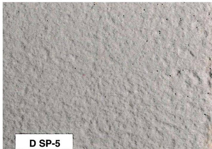
Βαθμός προετοιμασίας επιφανείας Sa 3 (Λευκή ψηγματοβολή-White Metal Blast Cleaning)
