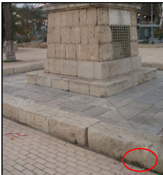
Φωτογραφία 3.3. Υψομετρική αφετηρία τοποθετημένη στο μνημείο του Γ. Καραϊσκάκη (R1)
