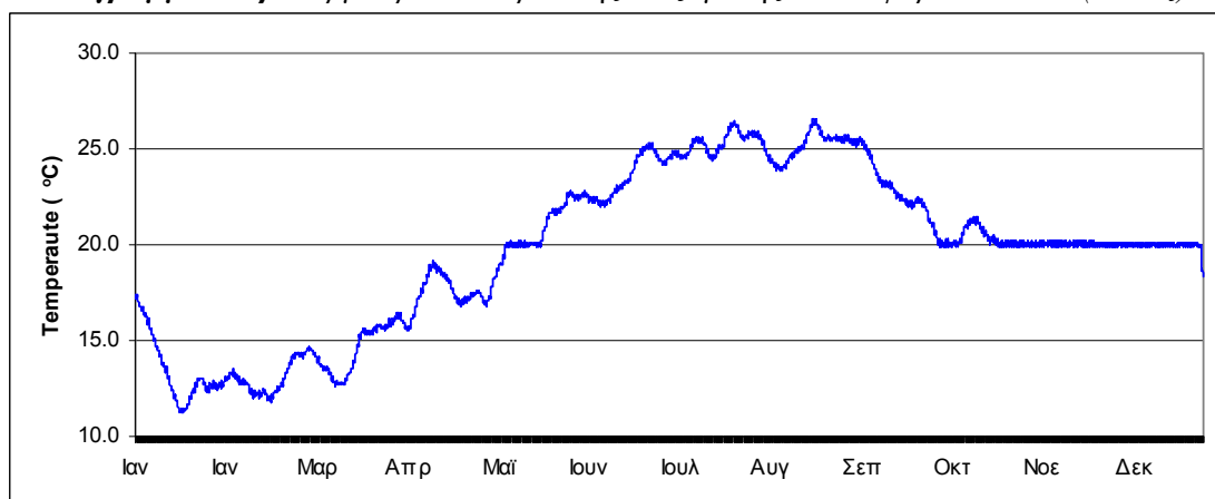
Διάγραμμα 5.7γ Θερμοκρασία του αέρα στο εσωτερικό του κτηρίου (3 έτος)
