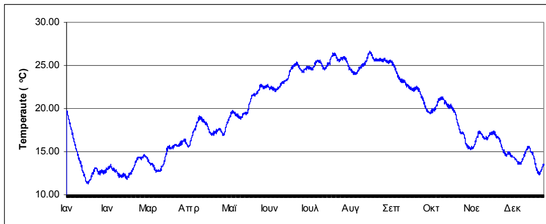
Εικόνα 5.7 Θερμοκρασία του κτηρίου χωρίς σύστημα θέρμανσης ( L=15\text{W/m}^2 )
