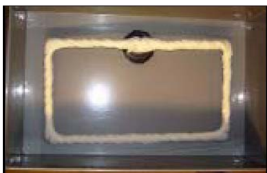
Φώτο 6 Κάλυψη του διάτρητου σωλήνα αποστράγγισης με υφασμάτινο φίλτρο
