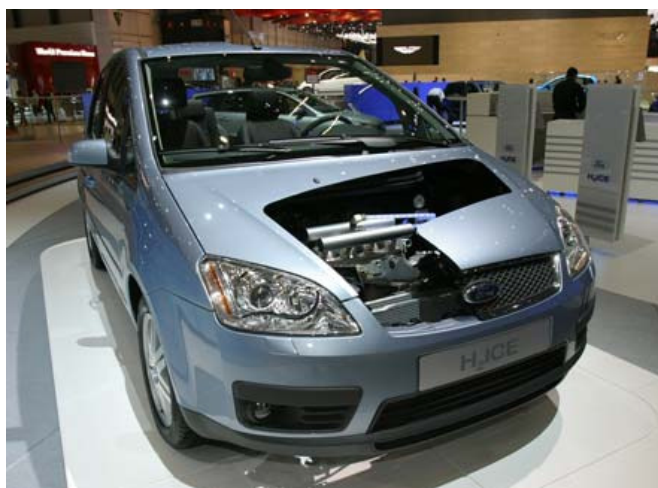
Εικόνα 5.19: Το πρωτότυπο όχημα της Ford με κινητήρα χωρητικότητας 2,3 λίτρων, το Focus C-Max H 2 ICE.
