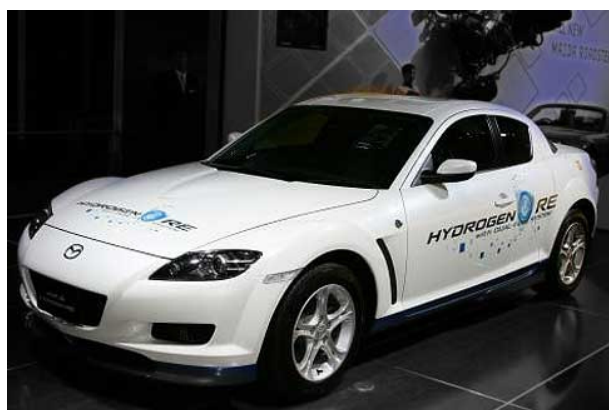
Εικόνα 5.23: Το πρωτότυπο μοντέλο υδρογόνου της MAZDA, RX-8 RE με τον κινητήρα περιστρεφόμενου εμβόλου τύπου Wankel.
