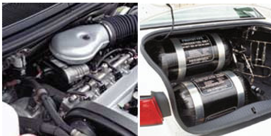
Εικόνα 5.17: Ο κινητήρας καύσης υδρογόνου και οι δεξαμενές καυσίμου στο χώρο αποσκευών του Ford P2000.
