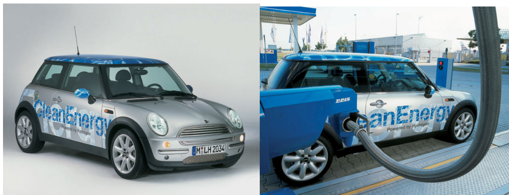
Εικόνα 5.10: Το BMW MINI Cooper Hydrogen που αποκαλύφθηκε στην Έκθεση Αυτοκινήτου της Φρανκφούρτης το 2001. Δεξιά, κατά τη διάρκεια ανεφοδιασμού στο σταθμό ανεφοδιασμού του αεροδρομίου του Μονάχου.
