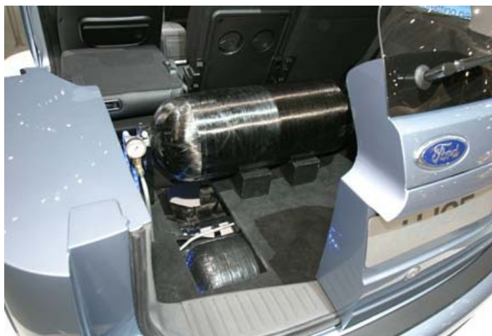
Εικόνα 5.21: Οι φιάλες που περιέχουν το υδρογόνο υπό πίεση 350bar στο πίσω μέρος του εκθεσιακού Ford Focus C-Max H 2 ICE. Το πάτωμα είναι κομμένο για να διακρίνεται η φιάλη κάτω από το πάτωμα.
