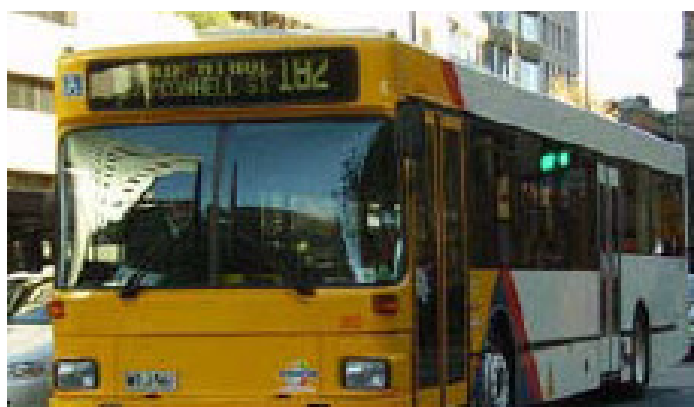
Εικόνα 5.27: Το λεωφορείο SL202 κανονικού δαπέδου της MAN με τον κινητήρα διττής επιλογής καυσίμου H 2866 UH.
