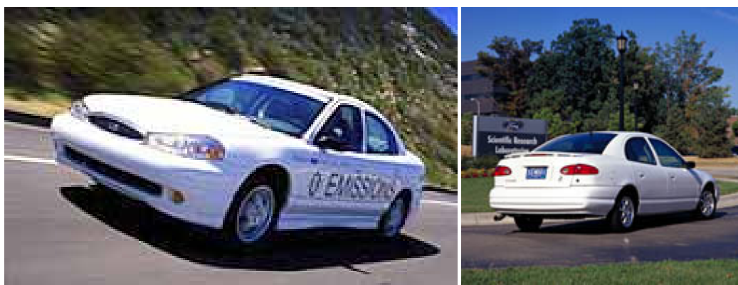
Εικόνα 5.16: Το πρωτότυπο αυτοκίνητο της Ford με μηχανή εσωτερικής καύσης υδρογόνου, το P2000.
