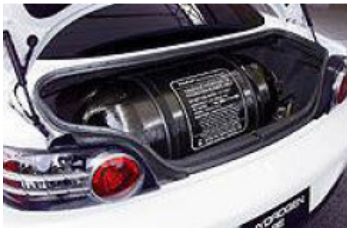
Εικόνα 5.25: Η δεξαμενή υδρογόνου στον χώρο αποσκευών του οχήματος.
