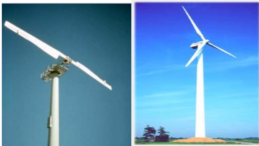
Σχήμα 2.2 : Τρίπτερη Α/Γ στην φωτογραφία δεξιά και δίπτερη στην αριστερή[Κ.ΑΠ.Ε]
