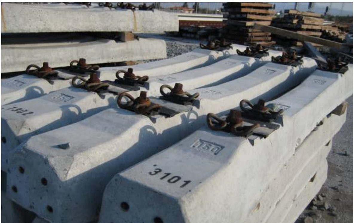
Εικόνα 21. Συνήθης τύπος ολόσωμου στρωτήρα με προσαρμοσμένα τα ελαστικά τεμάχια έδρασης, τα στριφώνια και τα ελατήρια.
