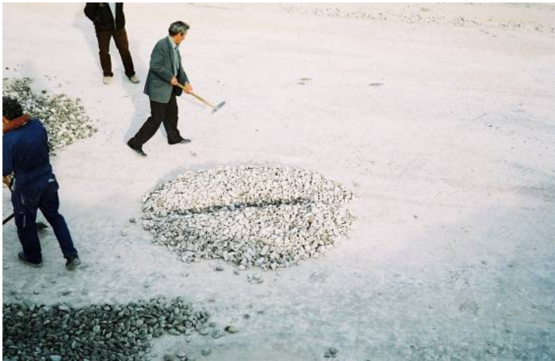
Εικόνα 95. Έναρξη τετραμερισμού με πρώτο τεμαχισμό στην μέση
