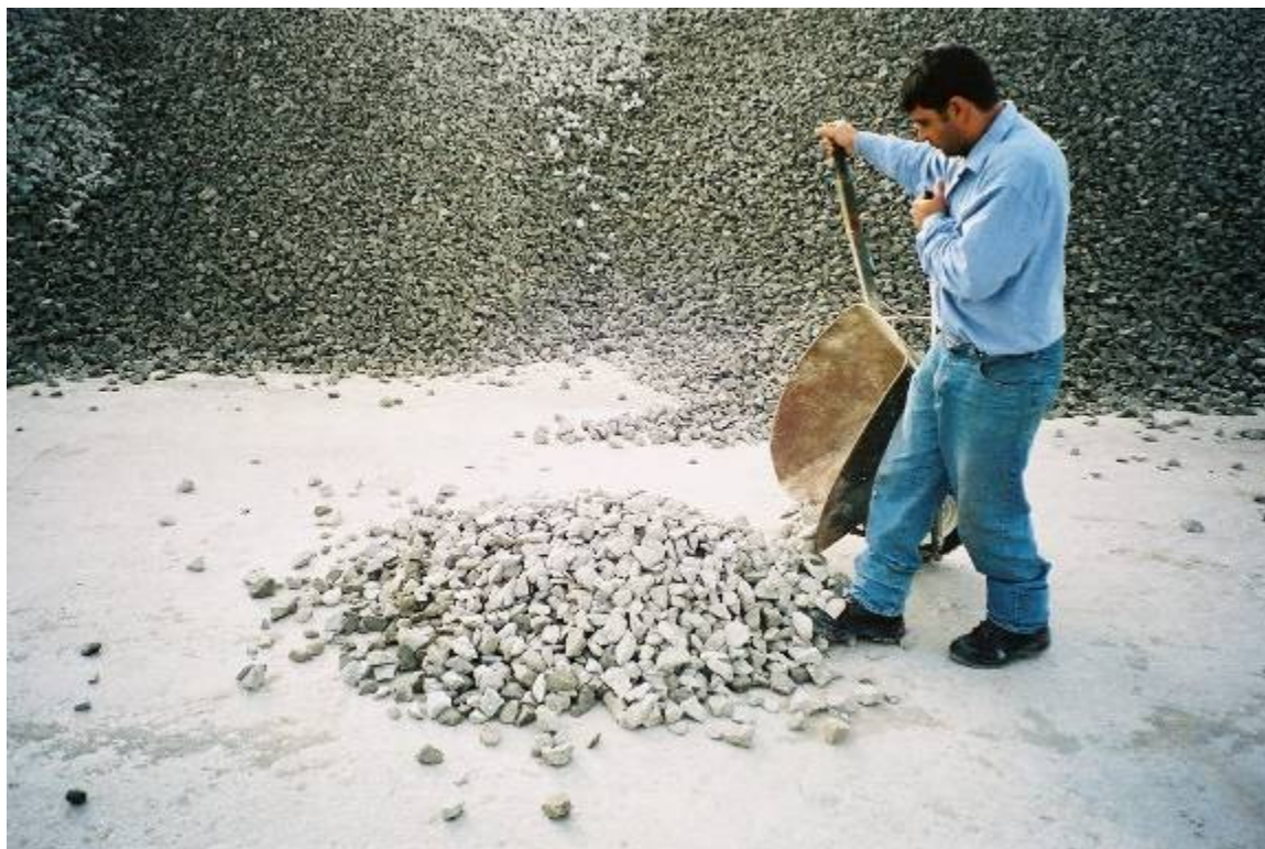
Εικόνα 91. Έναρξη σχηματισμού δειγματοληπτικού σωρού.
