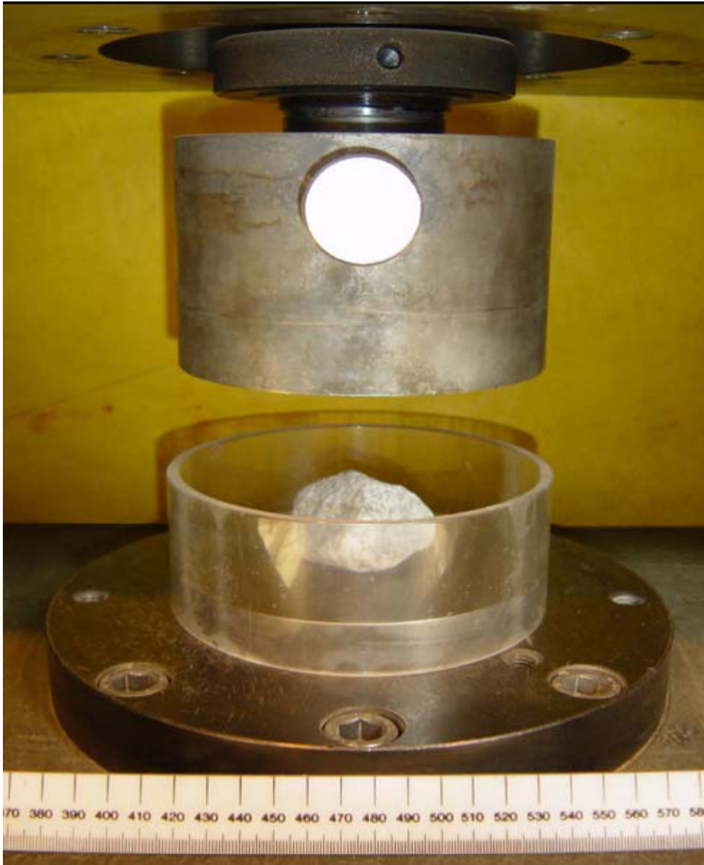
Εικόνα 77. Θλίψη μεμονωμένου κόκκου ακανόνιστου σχήματος
