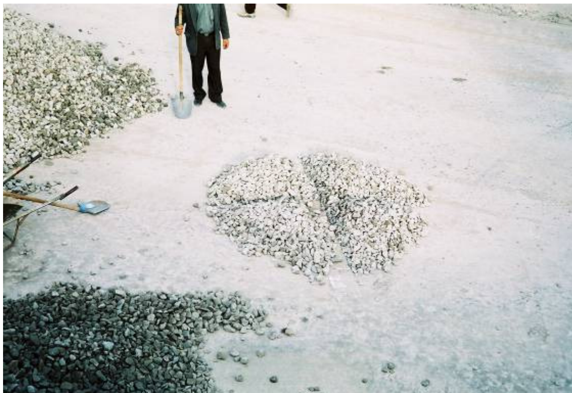
Εικόνα 98. Τετραμερισμός στο δειγματοληπτικό σωρό
