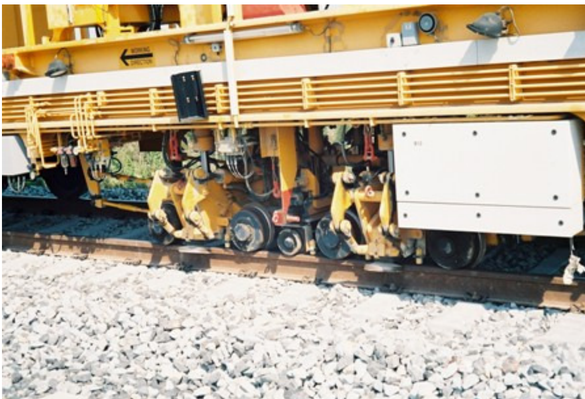
Εικόνα 63. Κάτω τμήμα Σταμπιλιζάτορα
