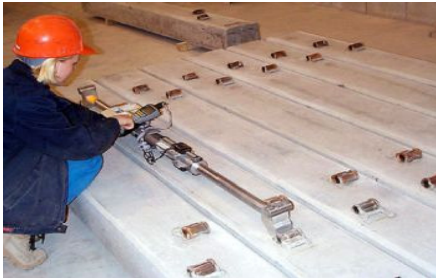
Εικόνα 11. Μέτρηση εύρους κατά την παραλαβή στρωτήρων
