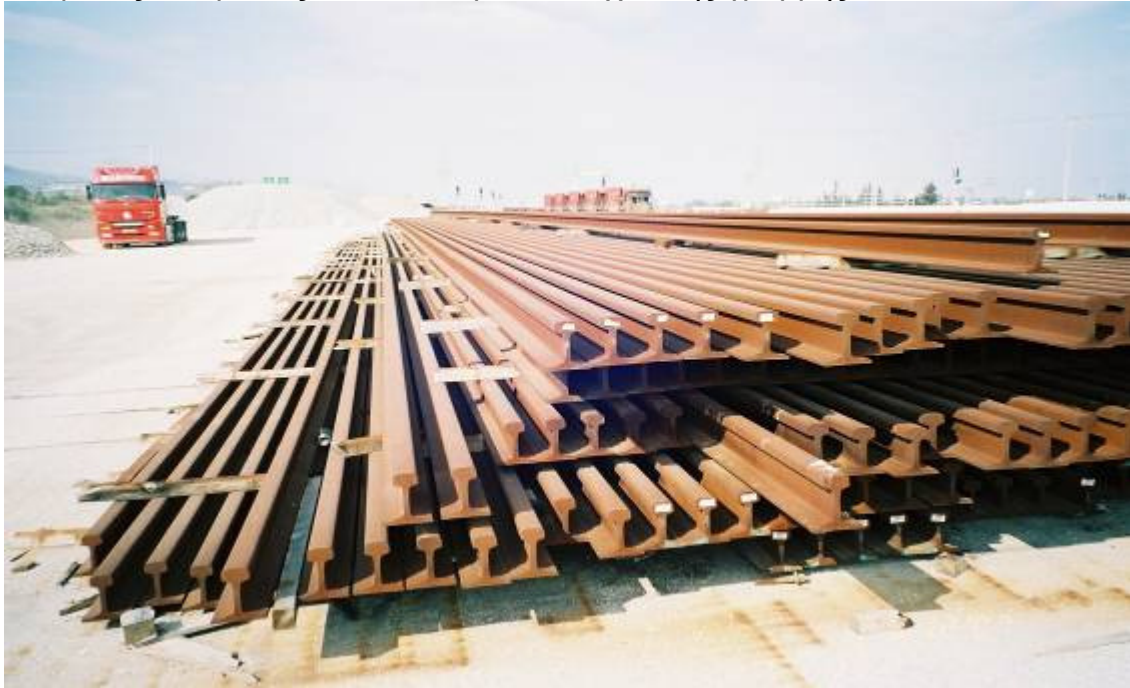
Εικόνα 6. Σιδηροτροχιές βάρους 60 kg/m σε εγκάρσια τομή
