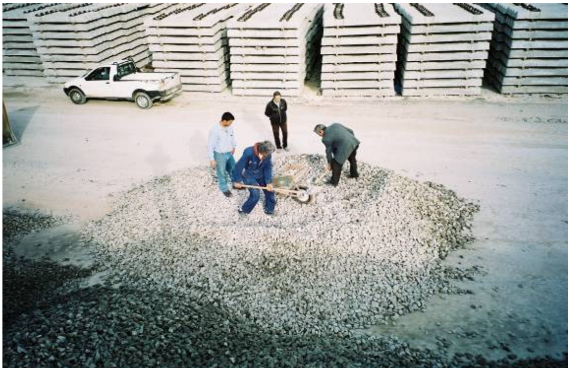
Εικόνα 89. Συνέχεια απομείωσης του δείγματος – λήψη στο κέντρο.
