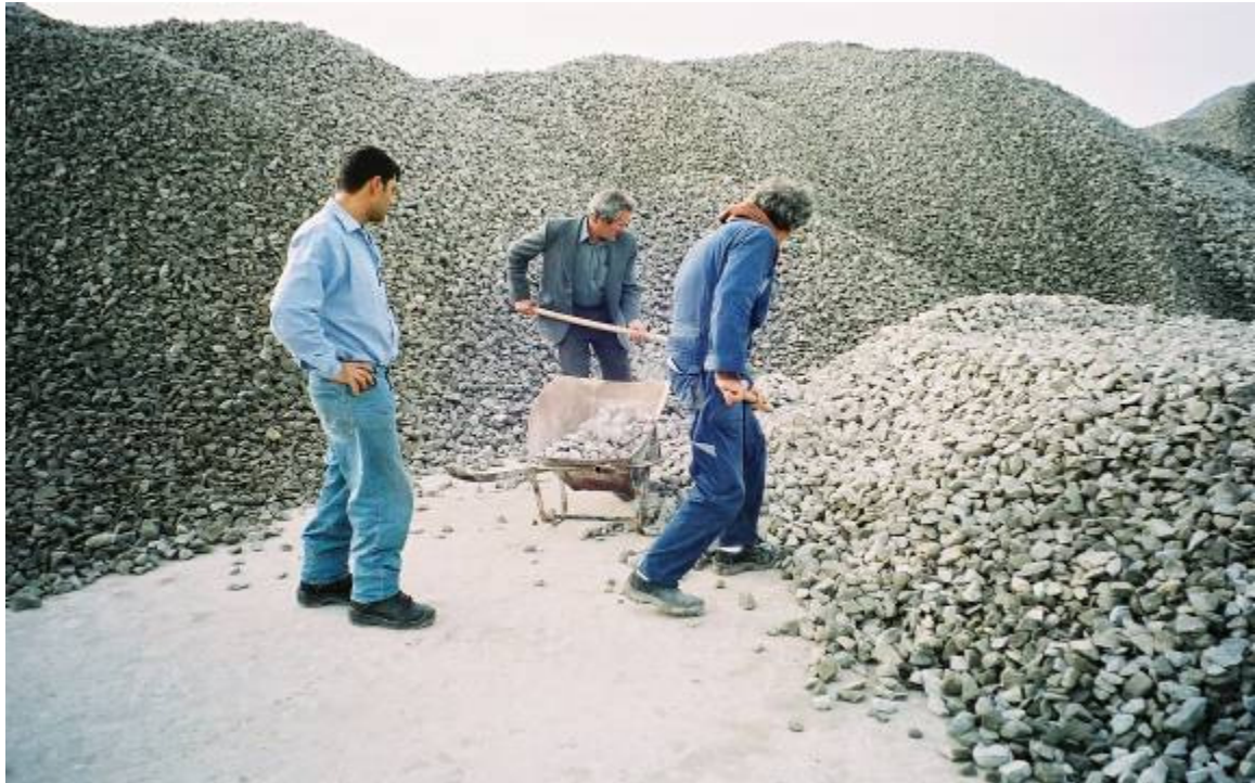
Εικόνα 88. Απομείωση του δείγματος προκειμένου να δημιουργηθεί ο δειγματοληπτικός σωρός (πλευρική λήψη).
