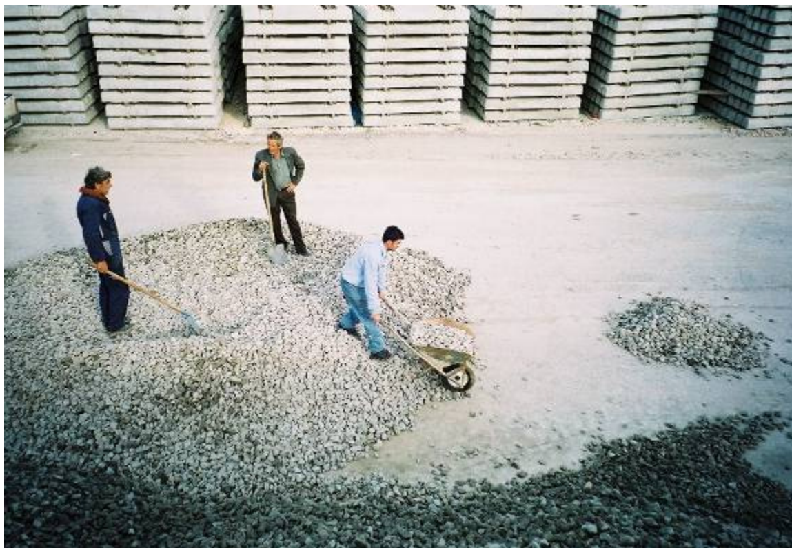
Εικόνα 90. Συνέχεια απομείωσης δείγματος, μεταφορά των προσαυξήσεων για τη δημιουργία ενός μικρότερου (δειγματοληπτικού σωρού).
