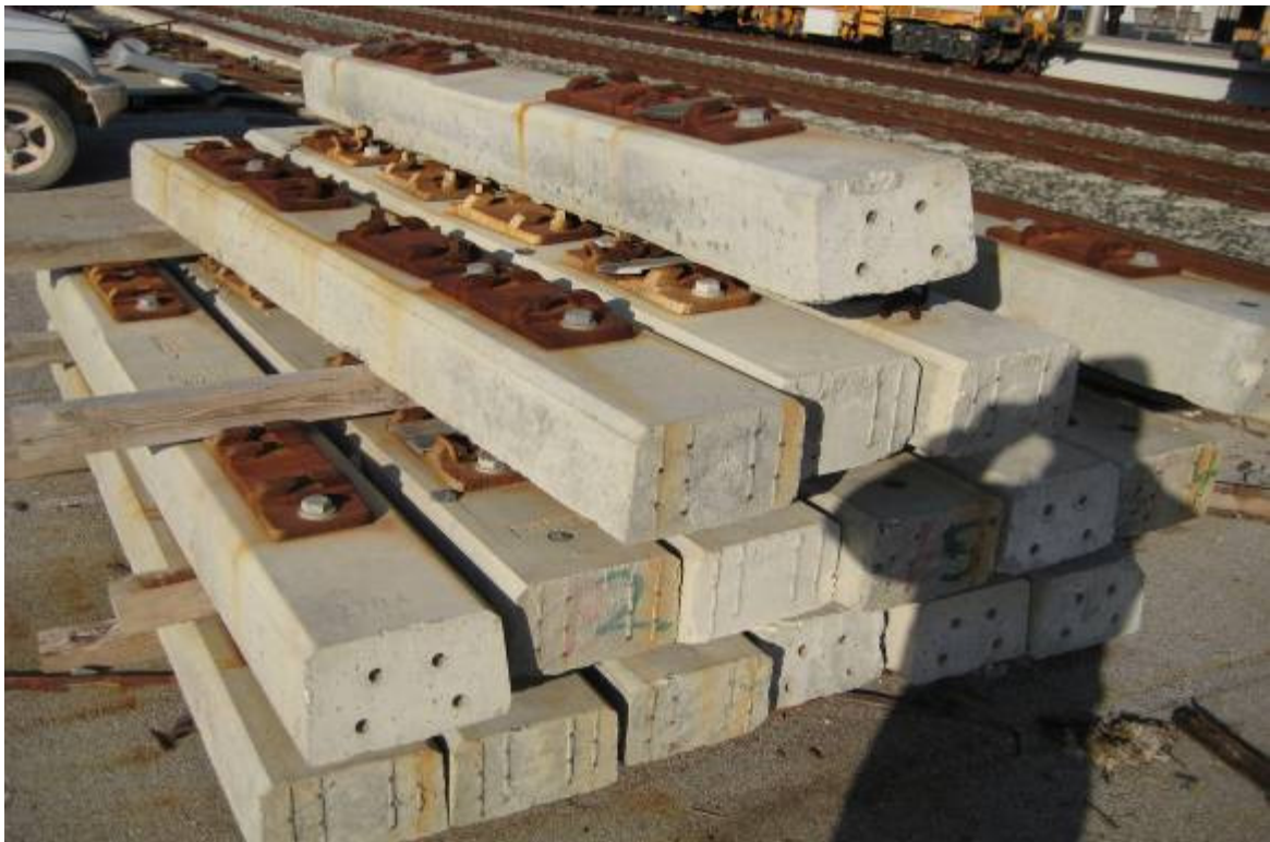
Εικόνα 19. Ενισχυμένοι στρωτήρες για διπλή (κόντρα) σιδηροτροχιά
