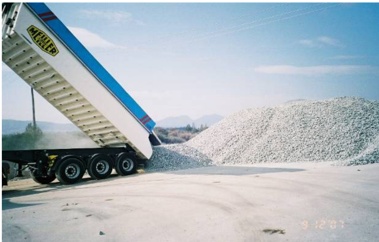
Εικόνα 87. Παράδοση - αποθήκευση σιδ/κών αδρανών από τραχανδεσίτη Ν. Λήμνου (Ν.Σ.Σταθμός Κορίνθου).
