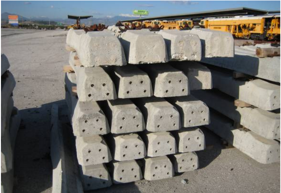
Εικόνα 20. Συνήθης τύπος ολόσωμου στρωτήρα γραμμής υψηλής ταχύτητας
