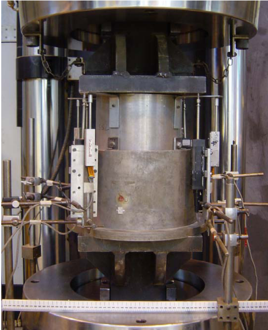
Εικόνα 79. Κυψέλη στερεοποίησης υψηλής κλίμακας (consolidometer).
