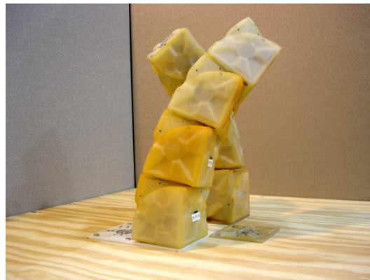
Σχήμα 1.11: [Αριστερά] Το μηχανικό κύτταρο “Molecube”. [Δεξιά] Ρομποτικές δομές αποτελούμενες από τέτοιου είδους μηχανικά κύτταρα.
