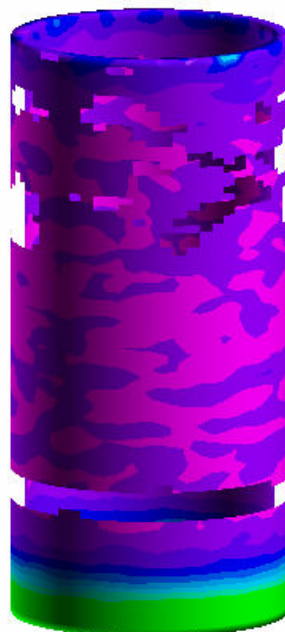
Εικόνα 4.8.10: Ισοδύναμες τάσεις κατά von Mises για τον εσωτερικό σωλήνα κατά τη χρονική στιγμή t=0.49msec
