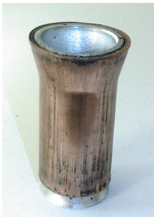
Εικόνα 2.27: Άποψη του δοκιμίου #9 (Δ9) μετά την κατεργασία της διέλασης
