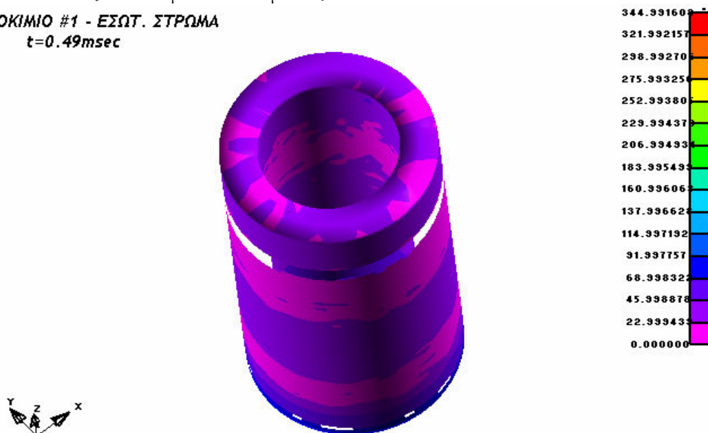
Εικόνα 4.1.10: Ισοδύναμες τάσεις κατά von Mises για τον εσωτερικό σωλήνα κατά τη χρονική στιγμή t=0.49msec
