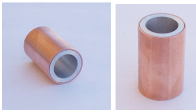
Εικόνες 2.20: Απόψεις του δοκιμίου #6 (Δ6) πριν την κατεργασία της διέλασης
