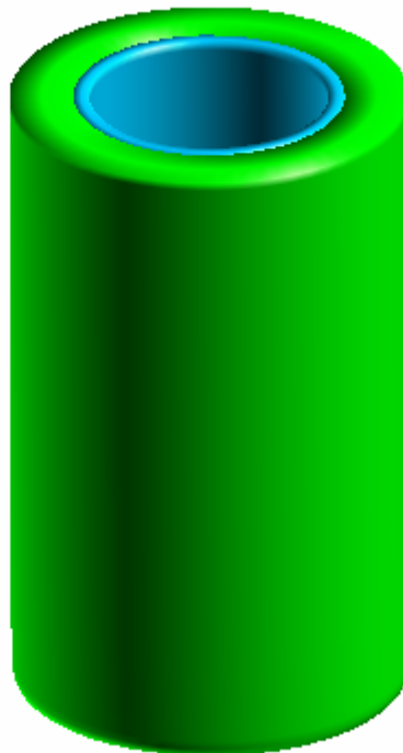
Εικόνα 4.5.1: Αναπαράσταση δοκιμίου #5 κατά την έναρξη της κατεργασίας διέλασης
