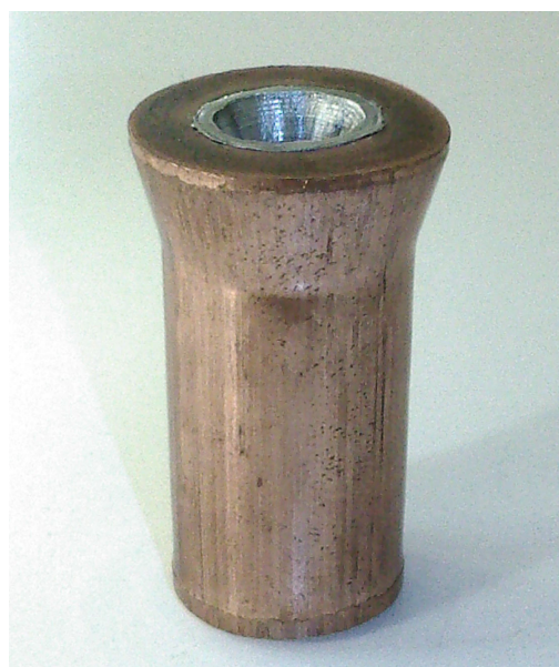
Εικόνα 2.19: Άποψη του δοκιμίου #5 (Δ5) μετά την κατεργασία της διέλασης
