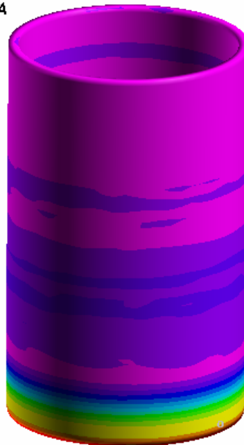
Εικόνα 4.9.7: Ισοδύναμες τάσεις κατά von Mises για τον εξωτερικό σωλήνα κατά τη χρονική στιγμή t=0.49msec
