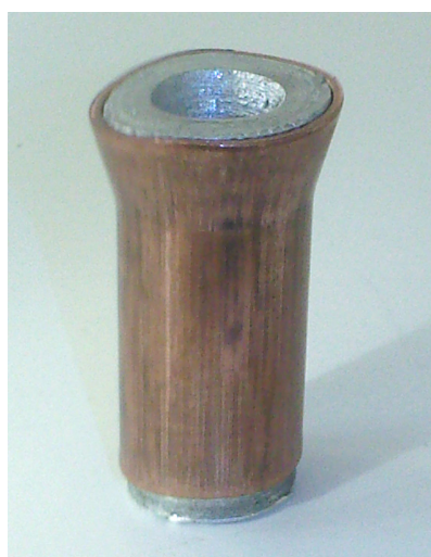
Εικόνα 2.11: Άποψη του δοκιμίου #1 (Δ1) μετά την κατεργασία της διέλασης
