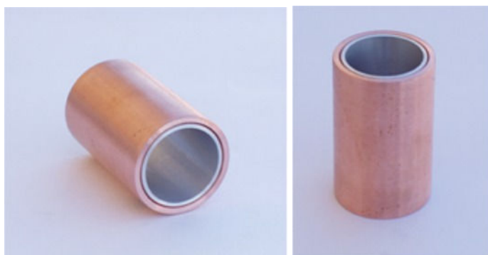
Εικόνες 2.30: Απόψεις του δοκιμίου #11 (Δ11) πριν την κατεργασία της διέλασης
