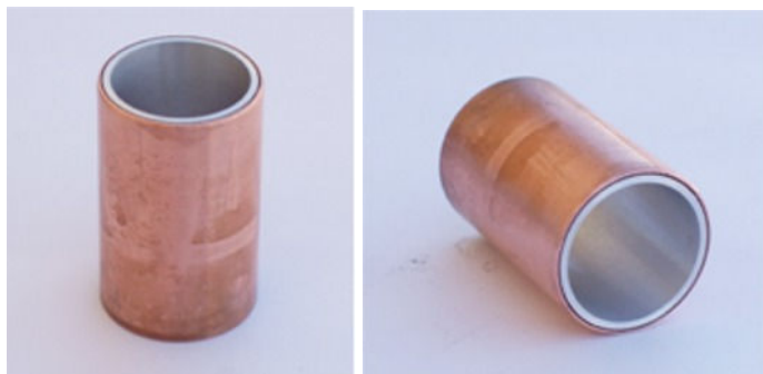
Εικόνες 2.32: Απόψεις του δοκιμίου #12 (Δ12) πριν την κατεργασία της διέλασης
