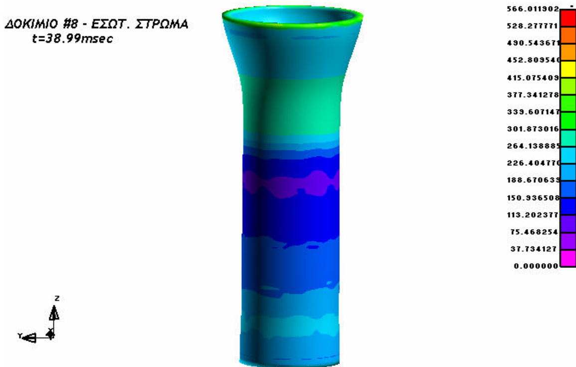
Εικόνα 4.8.11: Ισοδύναμες τάσεις κατά von Mises για τον εσωτερικό σωλήνα κατά τη χρονική στιγμή t=38.99msec
