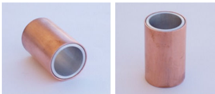
Εικόνες 2.26: Απόψεις του δοκιμίου #9 (Δ9) πριν την κατεργασία της διέλασης
