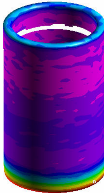
Εικόνα 4.2.7: Ισοδύναμες τάσεις κατά von Mises για τον εξωτερικό σωλήνα κατά τη χρονική στιγμή t=0.49msec
