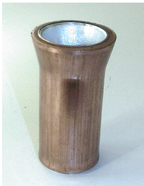
Εικόνα 2.31: Αποψη του δοκιμίου #11 (Δ11) μετά την κατεργασία της διέλασης
