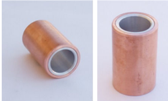
Εικόνες 2.22: Απόψεις του δοκιμίου #7 (Δ7) πριν την κατεργασία της διέλασης
