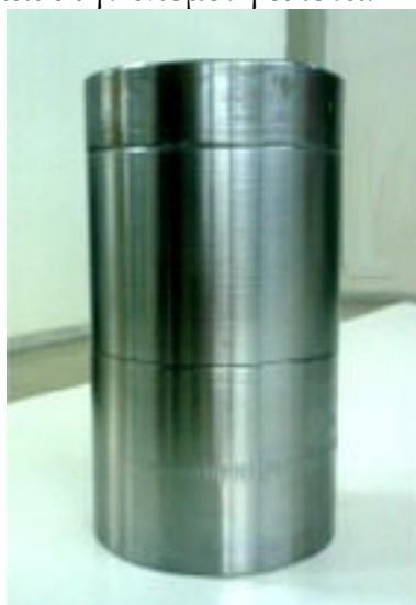
Εικόνα 2.4: Άποψη του συναρμολογημένου συνόλου των εξαρτημάτων της μήτρας
