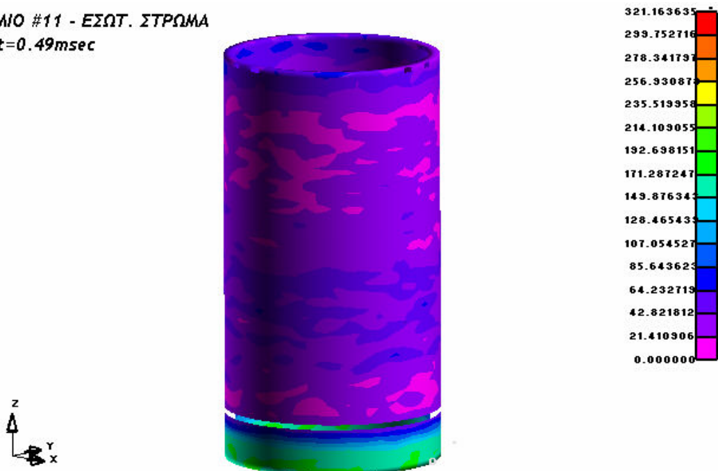
Εικόνα 4.11.10: Ισοδύναμες τάσεις κατά von Mises για τον εσωτερικό σωλήνα κατά τη χρονική στιγμή t=0.49msec
