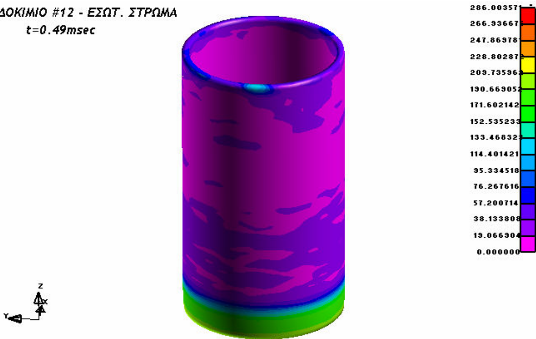
Εικόνα 4.12.10: Ισοδύναμες τάσεις κατά von Mises για τον εσωτερικό σωλήνα κατά τη χρονική στιγμή t=0.49msec
