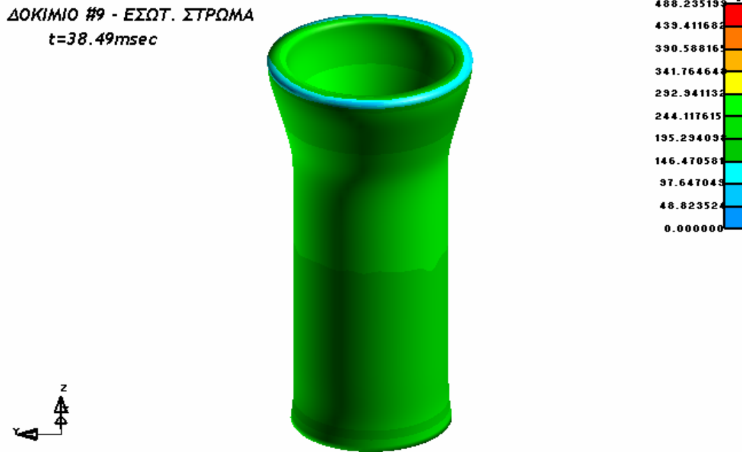
Εικόνα 4.9.11: Ισοδύναμες τάσεις κατά von Mises για τον εσωτερικό σωλήνα κατά τη χρονική στιγμή t=38.49\text{msec}
