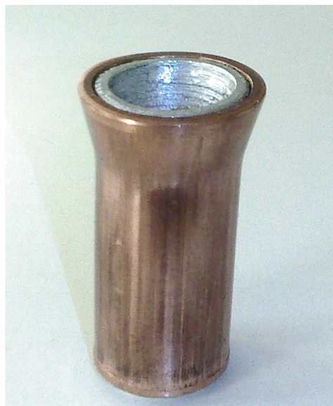
Εικόνα 2.23: Άποψη του δοκιμίου #7 (Δ7) μετά την κατεργασία της διέλασης
