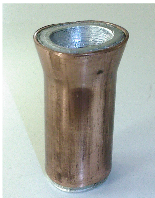
Εικόνα 2.21: Άποψη του δοκιμίου #6 (Δ6) μετά την κατεργασία της διέλασης
