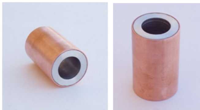
Εικόνες 2.10: Απόψεις του δοκιμίου #1 (Δ1) πριν την κατεργασία της διέλασης
