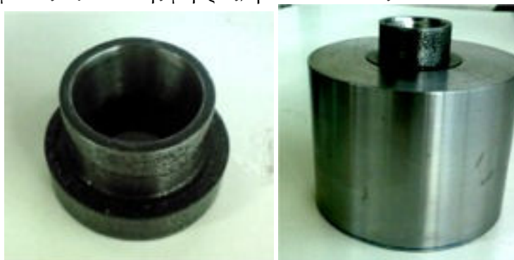
Εικόνες 2.2: Κωνικό τμήμα της μήτρας και άποψη του συνόλου «τμήμα εξόδου-κωνικό τμήμα»
