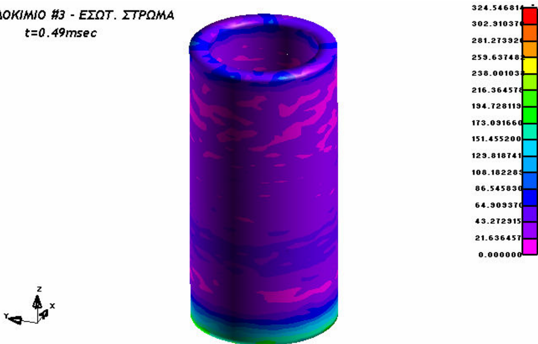
Εικόνα 4.3.10: Ισοδύναμες τάσεις κατά von Mises για τον εσωτερικό σωλήνα κατά τη χρονική στιγμή t=0.49msec
