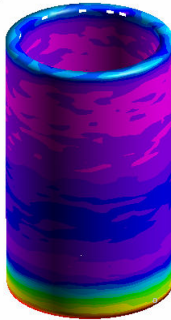
Εικόνα 4.11.7: Ισοδύναμες τάσεις κατά von Mises για τον εξωτερικό σωλήνα κατά τη χρονική στιγμή t=0.49msec
