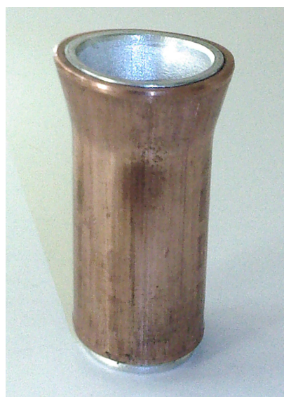
Εικόνα 2.29: Άποψη του δοκιμίου #10 (Δ10) μετά την κατεργασία της διέλασης
