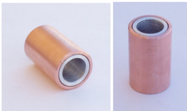
Εικόνες 2.14: Απόψεις του δοκιμίου #3 (Δ3) πριν την κατεργασία της διέλασης
