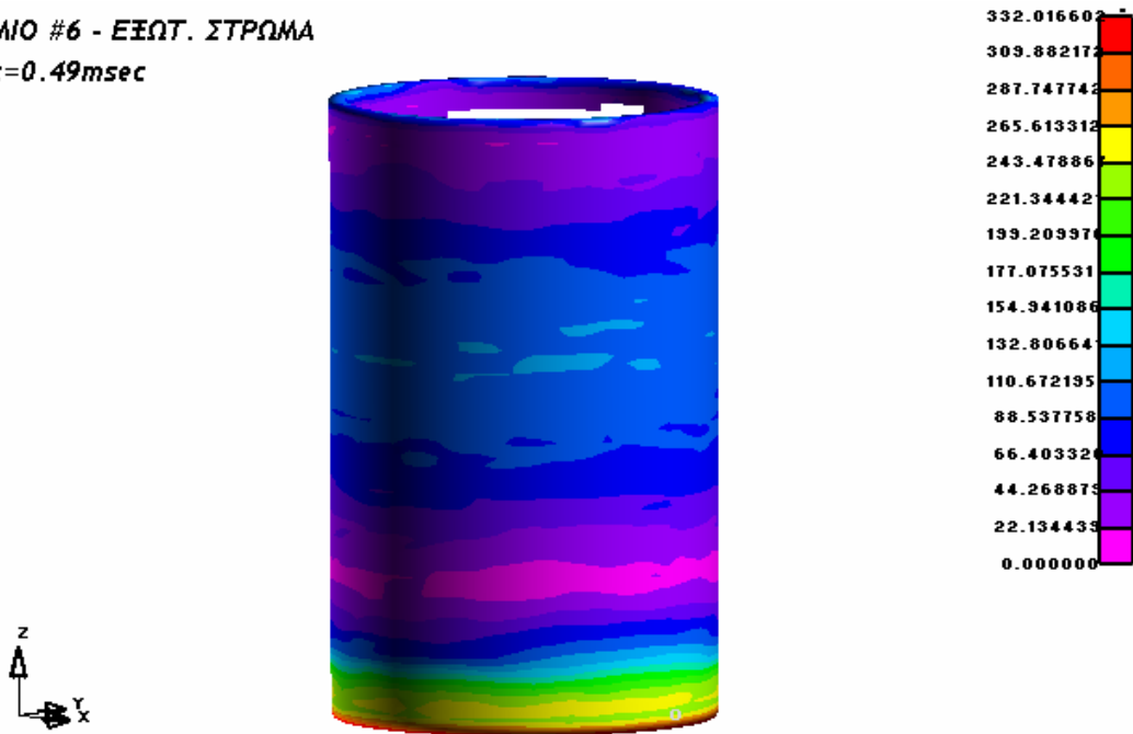
Εικόνα 4.6.7: Ισοδύναμες τάσεις κατά von Mises για τον εξωτερικό σωλήνα κατά τη χρονική στιγμή t=0.49msec
