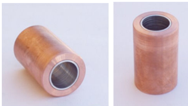
Εικόνες 2.18: Απόψεις του δοκιμίου #5 (Δ5) πριν την κατεργασία της διέλασης
