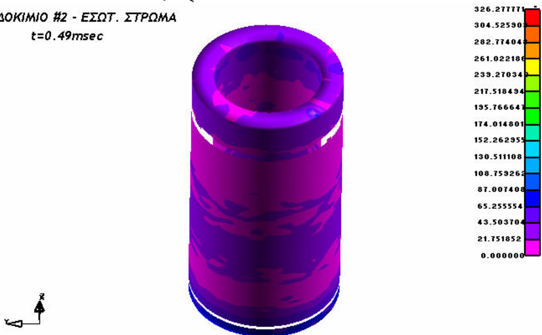
Εικόνα 4.2.10: Ισοδύναμες τάσεις κατά von Mises για τον εσωτερικό σωλήνα κατά τη χρονική στιγμή t=0.49msec
