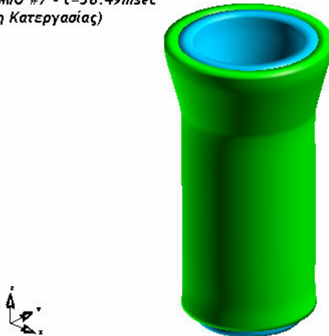
Εικόνα 4.7.3: Αναπαράσταση δοκιμίου #7 κατά τη λήξη της κατεργασίας διέλασης
