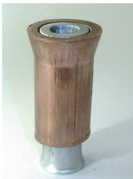
Εικόνα 2.15: Άποψη του δοκιμίου #3 (Δ3) μετά την κατεργασία της διέλασης
