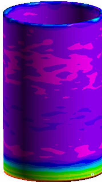
Εικόνα 4.1.7: Ισοδύναμες τάσεις κατά von Mises για τον εξωτερικό σωλήνα κατά τη χρονική στιγμή t=0.49msec
