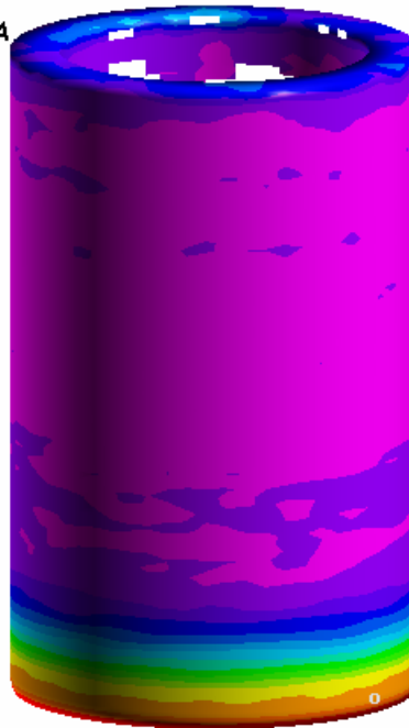
Εικόνα 4.8.7: Ισοδύναμες τάσεις κατά von Mises για τον εξωτερικό σωλήνα κατά τη χρονική στιγμή t=0.49msec
