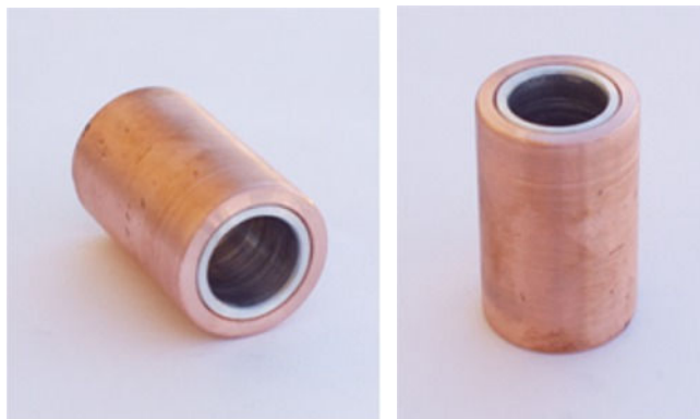
Εικόνες 2.16: Απόψεις του δοκιμίου #4 (Δ4) πριν την κατεργασία της διέλασης
