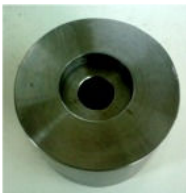
Εικόνα 2.1: Τμήμα εξόδου της μήτρας, φέρων διαμόρφωση για την τοποθέτηση του κωνικού δακτυλίου.
