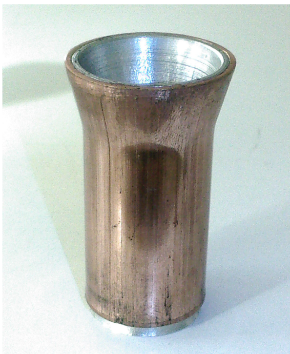
Εικόνα 2.33: Άποψη του δοκιμίου #12 (Δ12) μετά την κατεργασία της διέλασης
