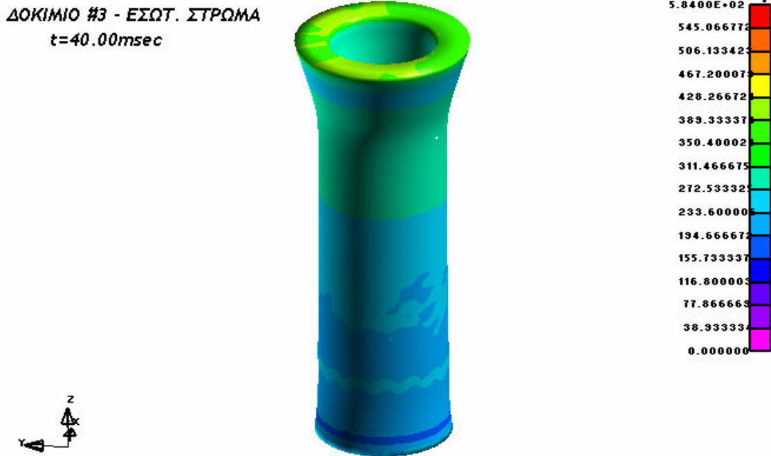
Εικόνα 4.3.11: Ισοδύναμες τάσεις κατά von Mises για τον εσωτερικό σωλήνα κατά τη χρονική στιγμή t=40.00msec
