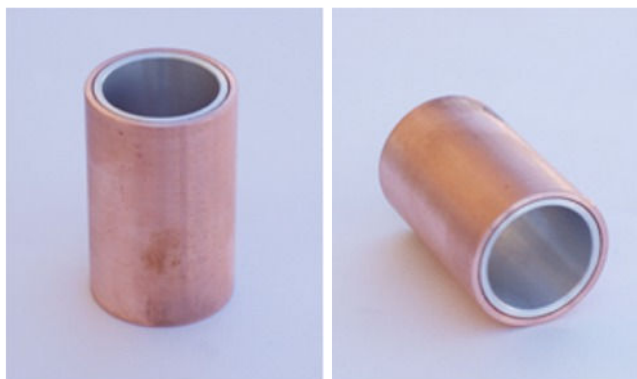
Εικόνες 2.28: Απόψεις του δοκιμίου #10 (Δ10) πριν την κατεργασία της διέλασης
