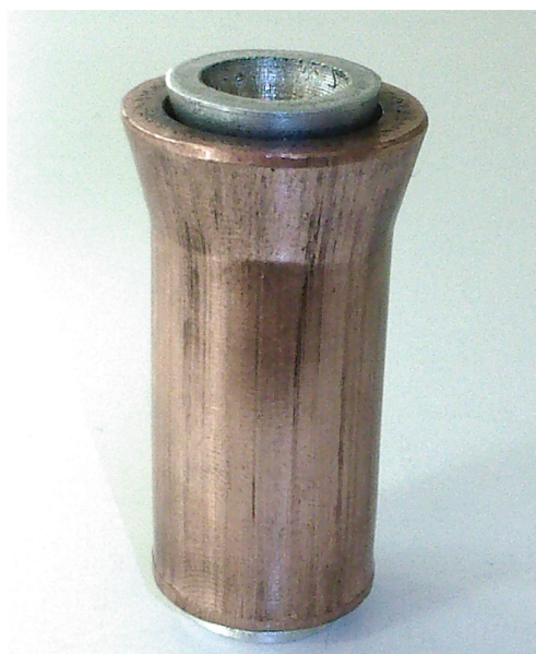
Εικόνα 2.17: Άποψη του δοκιμίου #4 (Δ4) μετά την κατεργασία της διέλασης
