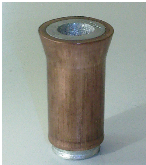
Εικόνα 2.13: Άποψη του δοκιμίου #2 (Δ2) μετά την κατεργασία της διέλασης
