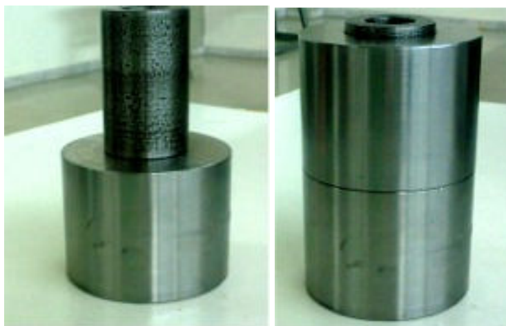
Εικόνες 2.3: Άποψη του δακτυλίου συγκράτησης και του τμήματος εισόδου στο συναρμολογημένο σύνολο.
