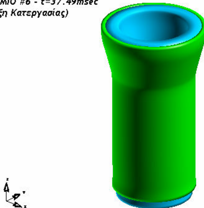
Εικόνα 4.6.3: Αναπαράσταση δοκιμίου #6 κατά τη λήξη της κατεργασίας διέλασης
