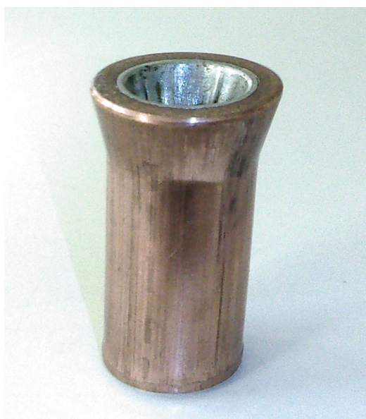
Εικόνα 2.25: Άποψη του δοκιμίου #8 (Δ8) μετά την κατεργασία της διέλασης
