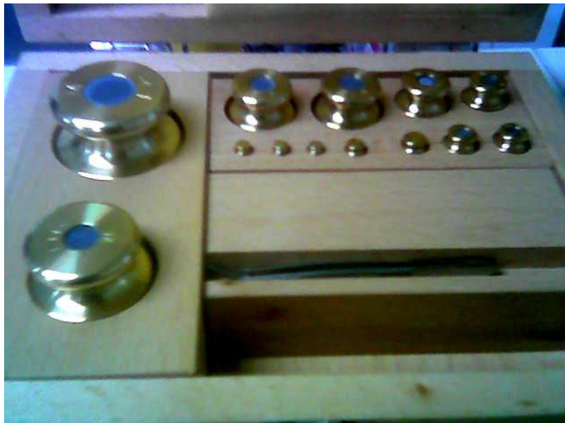
Εικόνα 10. Τα πρότυπα βαρίδια που χρησιμοποιήθηκαν για τη βαθμονόμηση.
