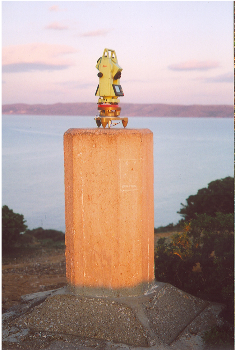
Φωτογραφία 2.1: Ο ολοκληρωμένος γεωδαιτικός σταθμός της Leica TCR 303, στο τριγωνομετρικό σημείο T
