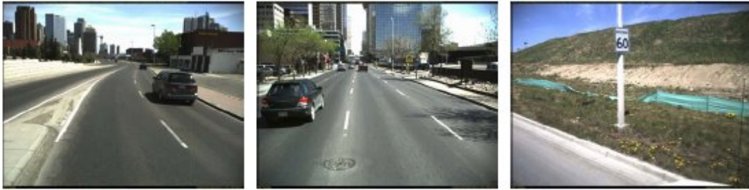
Εικόνα 2.6 Παράδειγμα εικόνων που καταγράφονται από το VISAT™ (Η πρώτη εικόνα θα μπορούσε να χρησιμοποιήσει στην καταγραφή των νησίδων κυκλοφορίας, η δεύτερη στην καταγραφή οδικής διαγράμμισης και η τελευταία εικόνα στην αυτόματη εξαγωγή οδικού σήματος)
