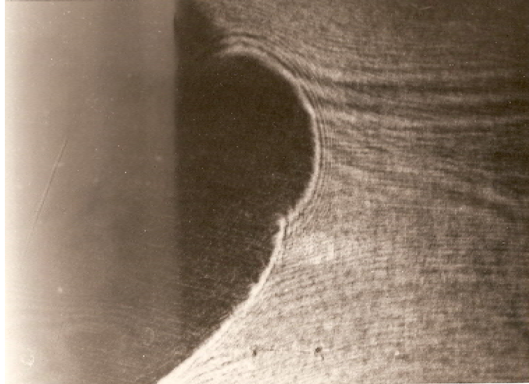
Εικόνα 21. Καυστική Δοκμίου 2, με επένδυση 80x100 mm για φορτίο 80kρ.
