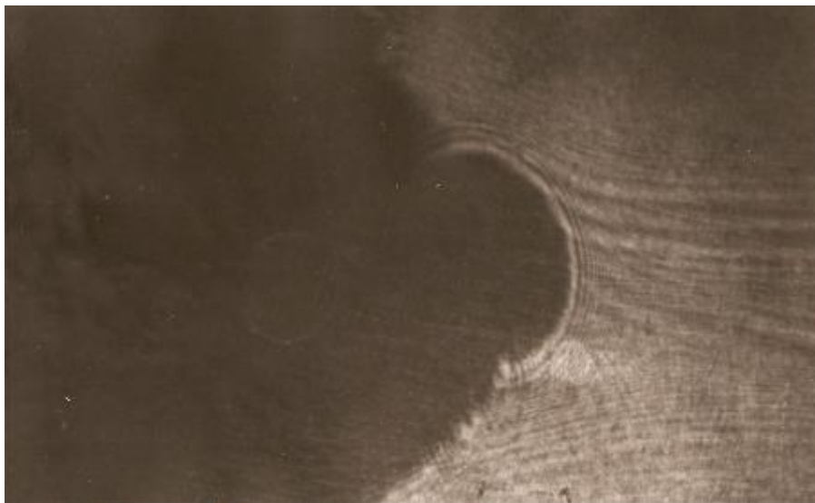
Εικόνα 24. Καυστική Δοκιμίου 2, με επένδυση 80x100 mm για φορτίο 180kp.
