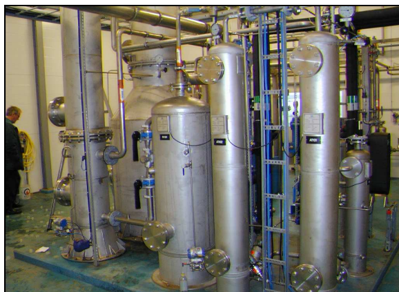
Εικόνα 16. Αναβάθμιση βιοαερίου με selexol (Πηγή: X. Ζαφείρης, ΚΑΠΕ)
