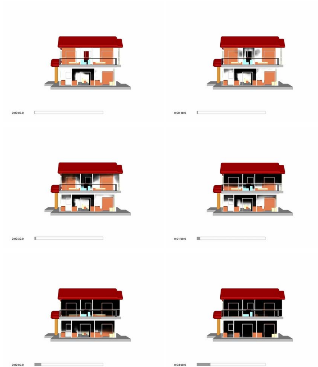
Σχήμα 4.5.3. Προλέξεις της κίνησης του καπνού (πλάγια όψη). Χρονική εξέλιξη (από πάνω αριστερά: 6s, 18s, 30s, 60s, 120s και 240s).
