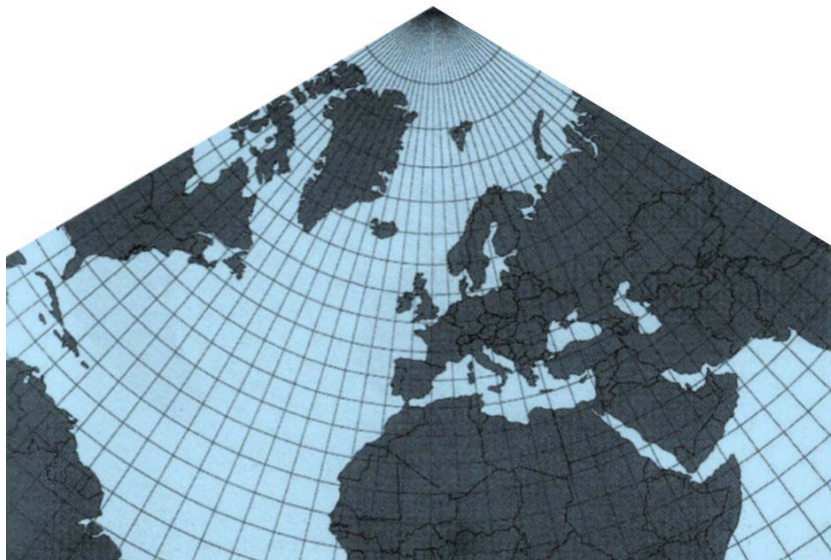
Σχήμα 1.14 Σύμμορφη κωνική προβολή Lambert Figure 1.14 Lambert conformal conical projection
