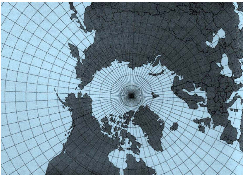
Σχήμα 1.15 Πολική ισαπέχουσα προβολή Figure 1.15 Polar equidistant projection
