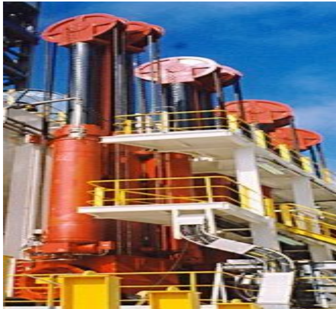
Εικόνα 1. Marine Riser Tensioners.
