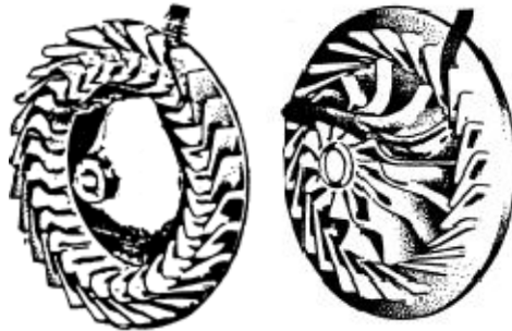
Εικόνα 5-42 : Ακτινικοί στρόβιλοι (αριστερά ακτινικής και δεξιά μικτής ροής)
